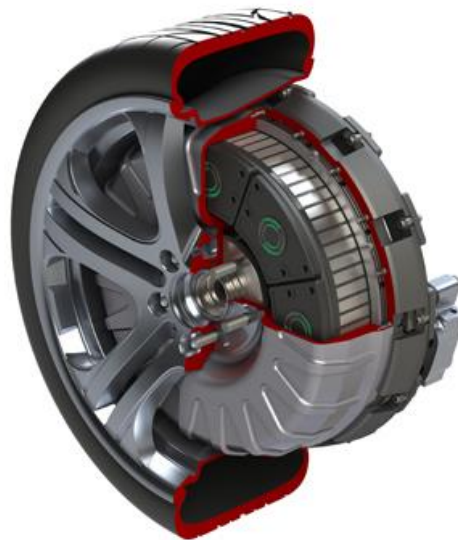
Obr. 1.4 Pohon od společnosti Protean Electric (převzato z [8])
