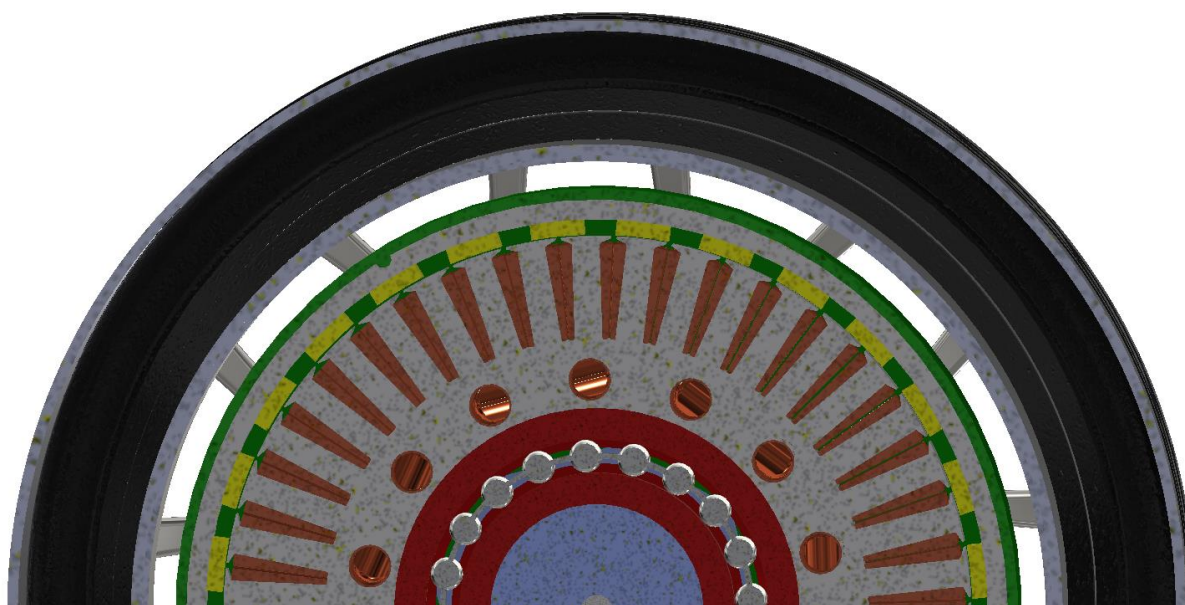
Obr. 7.2 Příčný řez konstrukcí kola
