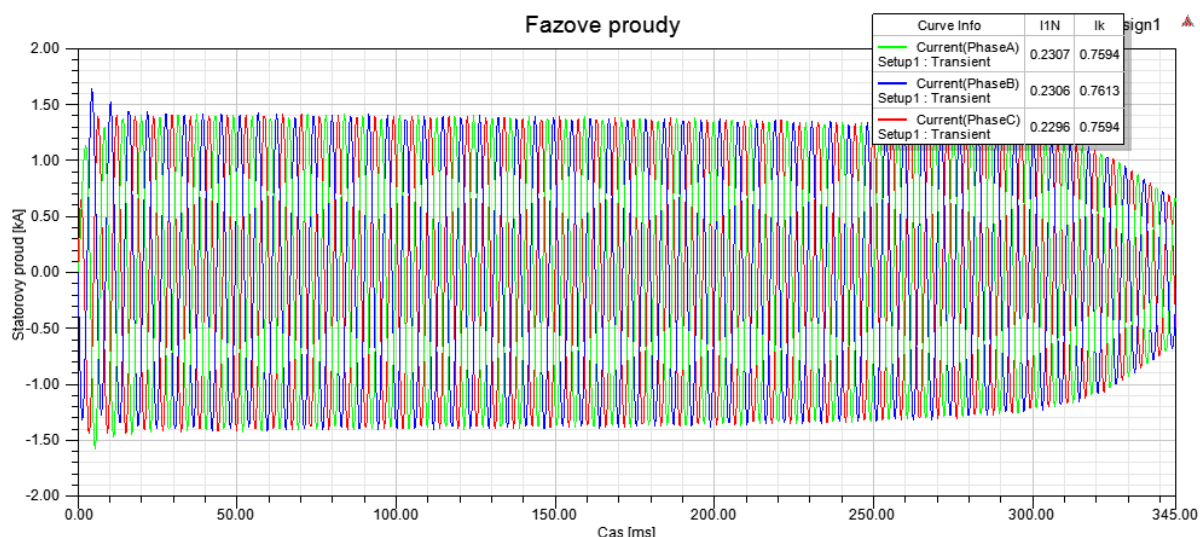
Obr. 3.18 – Graf proudů ve statorovém vinutí stroje při rozběhu k jmenovitým otáčkám
