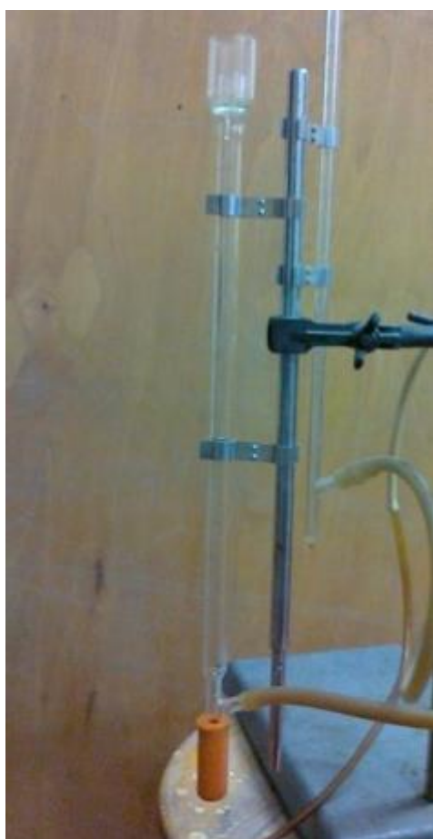
Obr.26: A: Bublinový průtokoměr – B: Padáčkový průtokoměr – a – stupnice, b – padáček určující průtok
