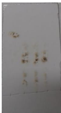
Obr.18: Chromatogram průběhu ozonizace – startovní body zleva: betulindiacetát; produkt po 30; 60; 90 minutách ozonizace.
