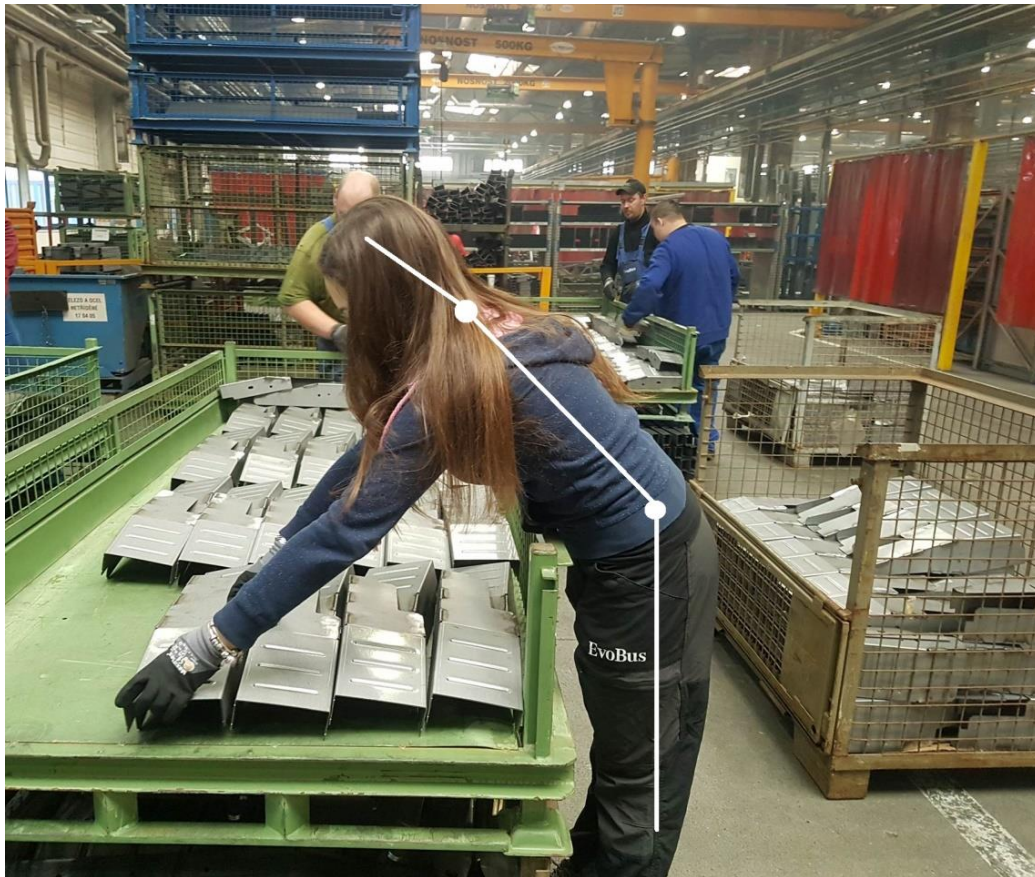
Obr. 3-4: Uchopení břemene při manipulaci – předklon trupu i krku, zdroj: vlastní zpracování
