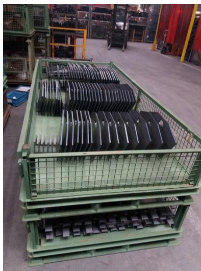
Obr. 2- 4: Paleta se speciálním hřebenem pro oddělení materiálu, zdroj: vlastní zpracování
