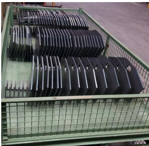
Obr. 4-7: Paleta s díly uloženými v hřebenu, zdroj: vlastní zpracování
