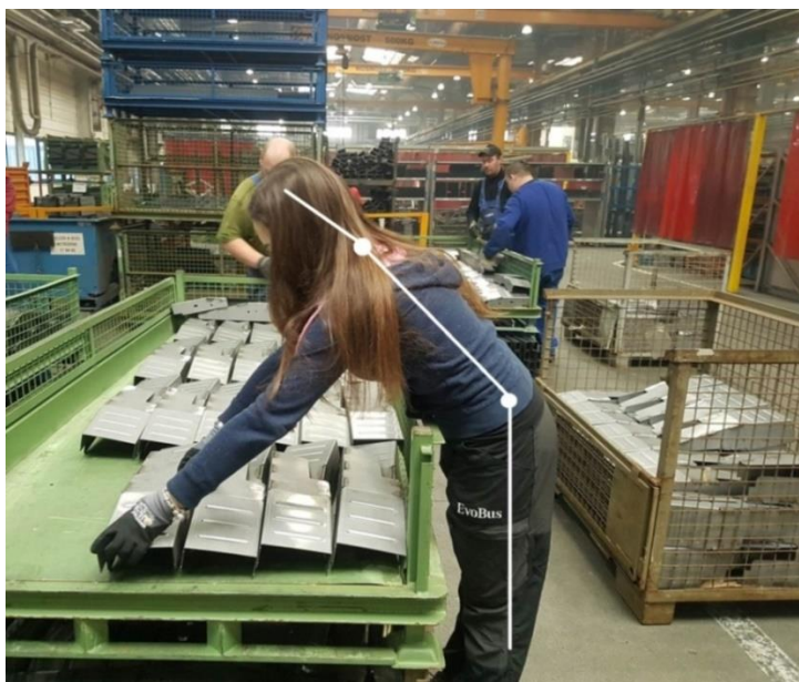
Obr. 4-1: Uchopení břemene při manipulaci – předklon trupu i krku, zdroj: vlastní zpracování
