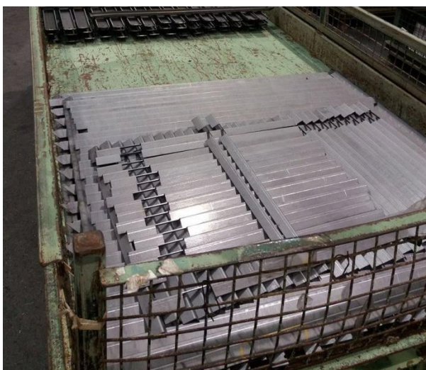
Obr. 4-8: Uložení tvarově složitějších dílů v paletě, zdroj: vlastní zpracování
