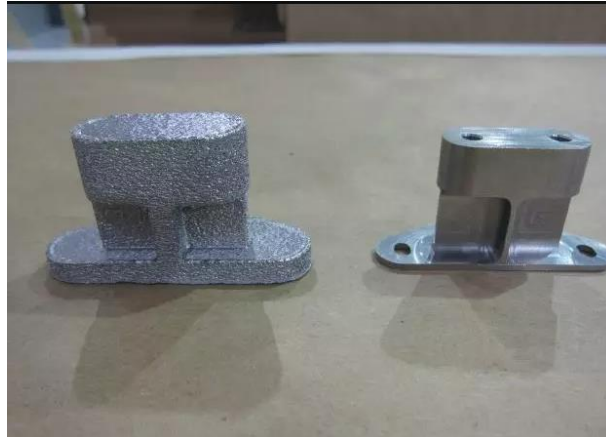
Obrázek 8 Před a po obrobení 3D tištěného kovového dílu [36]
