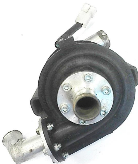
Obr. 22: Čerpadlo chladicí kapaliny vozu UWB04
