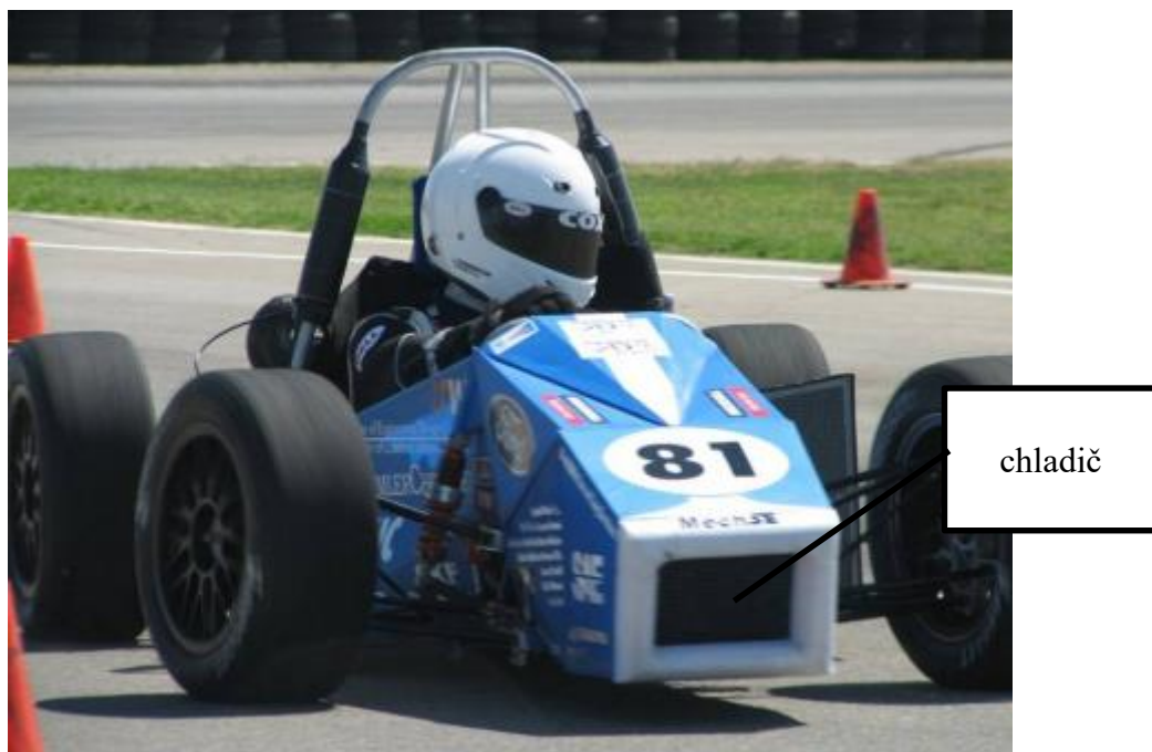
Obr. 19: Umístění chladiče v nosu formule [17]
