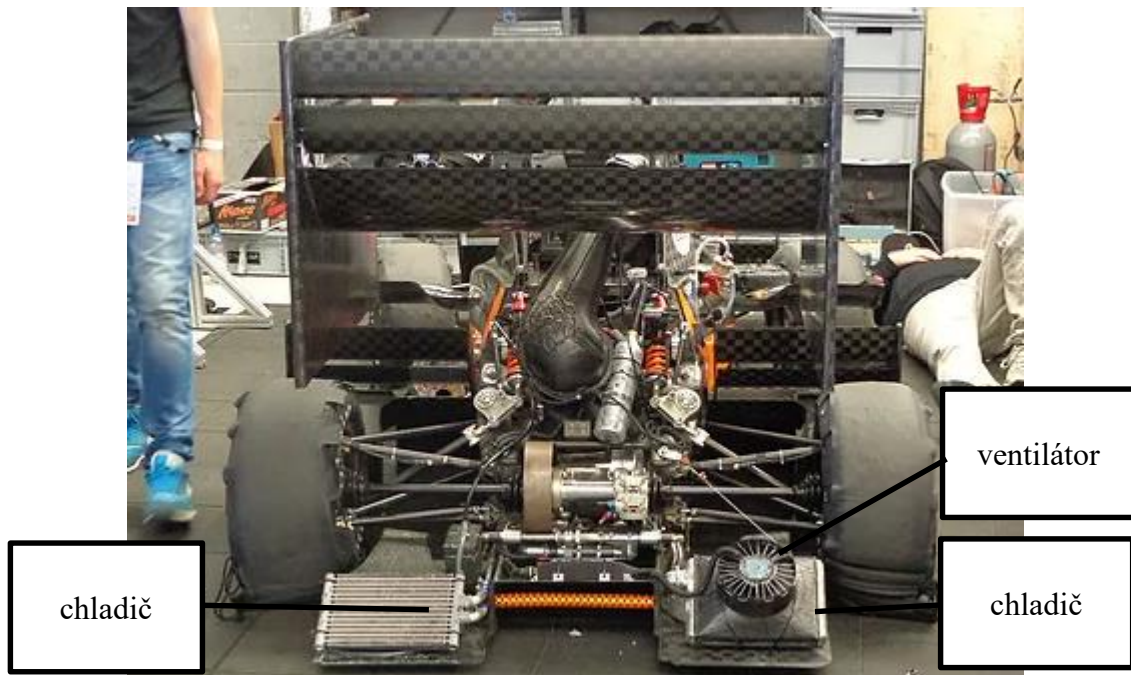
Obr. 18: Použití dvou chladičů umístěných na difuzoru [16]
