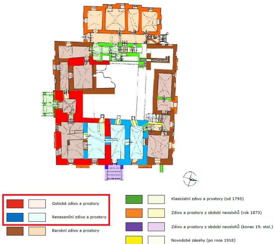
Obr. 2.1: Půdorys suterénu s legendou ze SHP, červeně jsou zvýrazněna období relevantní pro tuto práci (HANZLÍKOVÁ, LACINGER, 2002).
