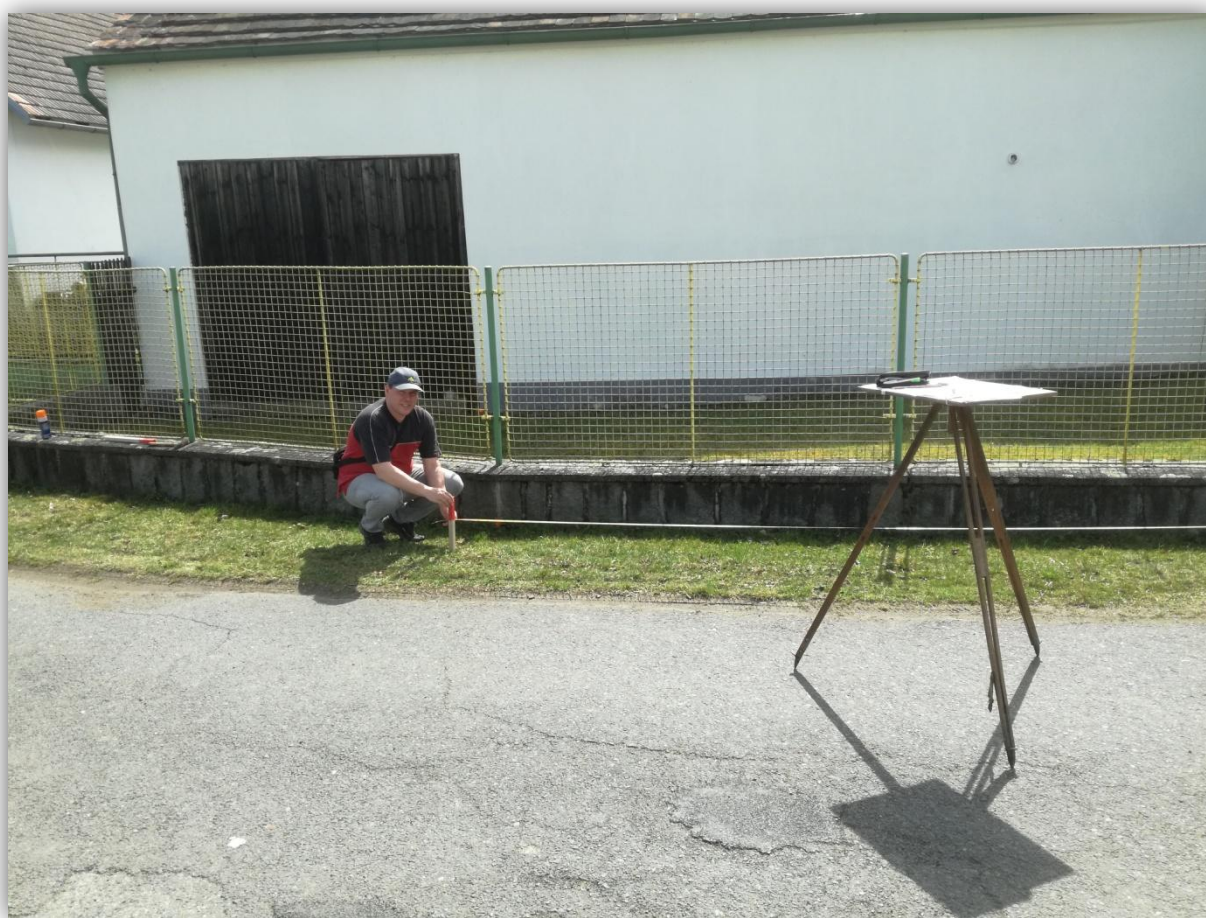
obr. 25 Terénní práce s využitím pásma a historického měřického stolku na trojnožce
