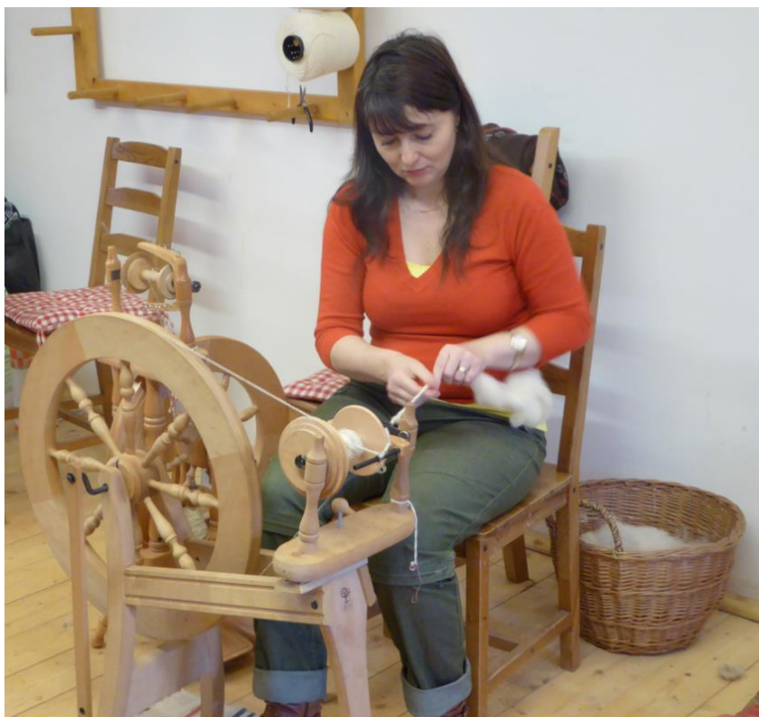
Sprádní vlny na kolovrátku náhrada za vřeteno
