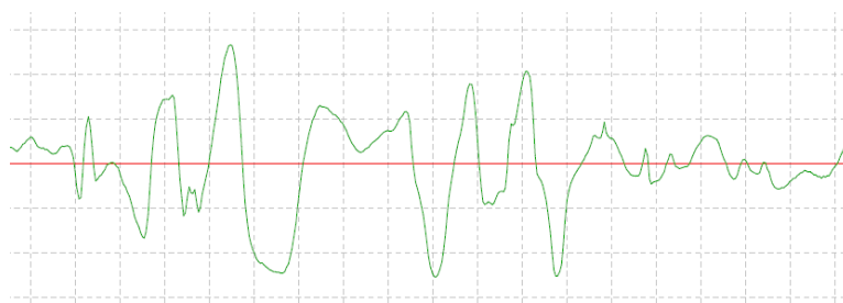
Obrázek 5-8 Otevřený profil se střední čarou[2,3,4]
