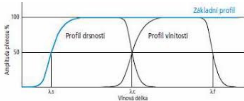
Obrázek 5-4 Přenosová charakteristika filtrace dat při měření drsnosti[16]
