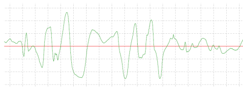
Obrázek 5-6 Otevřený profil drsnosti[2,3,4]
