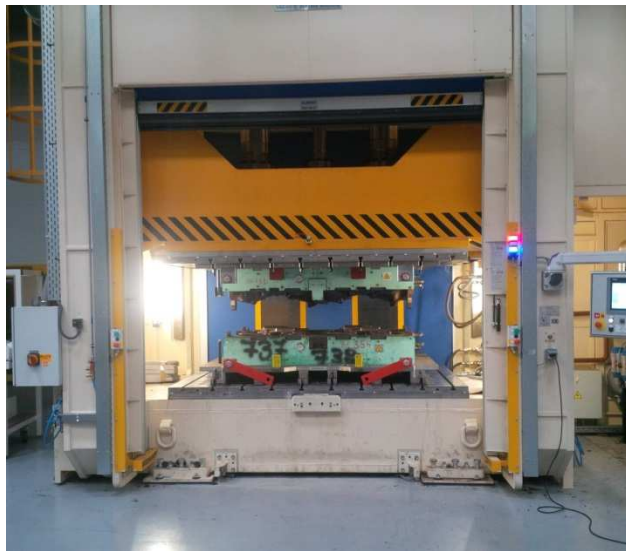
Obrázek 3-48: Lis 4000 kN použitý pro experimentální ověření posuvů a detail orýsování upínací desky
