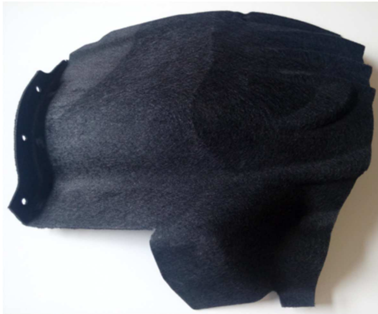
Obrázek 2-11: Příklad vzhledu části lisovaného dílu z tkaniny PE/PET
