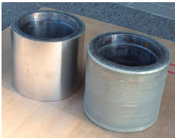
Obr. 2: Válcovací stolice; laserový návar Stellite 42 [14]
