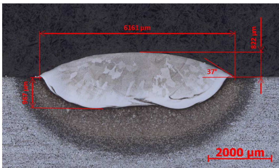
Obr. 30: E1_2750/40; měření geometrických charakteristik pomocí SM; leptáno; zvětšeno 50 x
