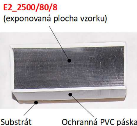
Obr. 64: E2_2500/80/8; úprava vzorku pomocí pásky z PVC
