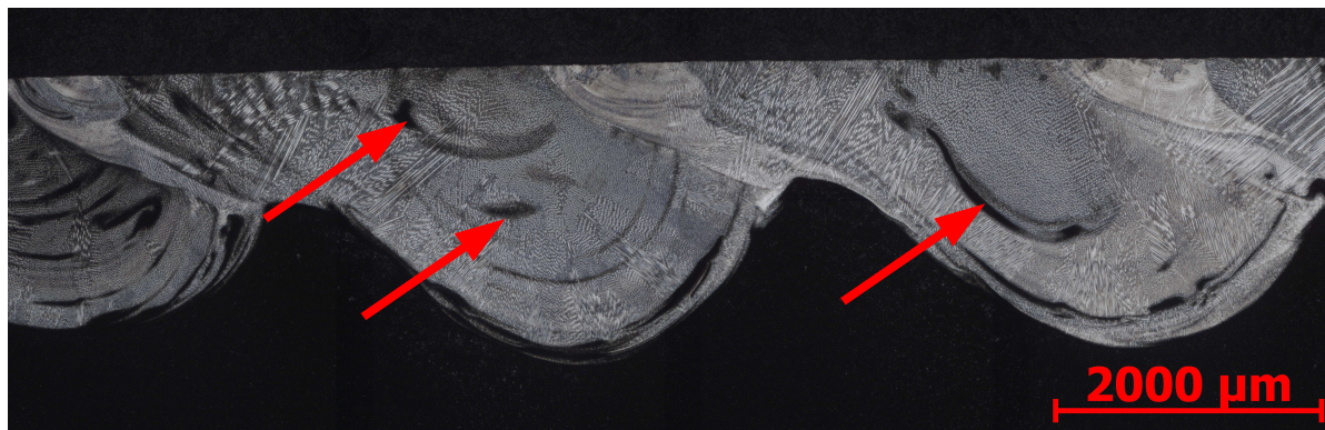
Obr. 20: Laserový návar Stellite 21 na substrátu z oceli S355; červené šípky směřují do oblastí, jež se vlivem Marangoniho efektu odlišují svými vlastnostmi od okolní matrice návaru; OM; leptáno Adler; zvětšeno 25x
