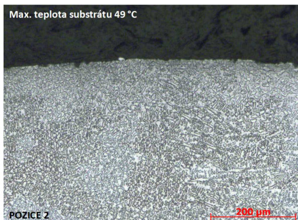
Obr. 54: E2_2000/120/0; POZICE 2 ; povrch laserového návaru Inconel 625; leptáno; zvětšeno 100 x
