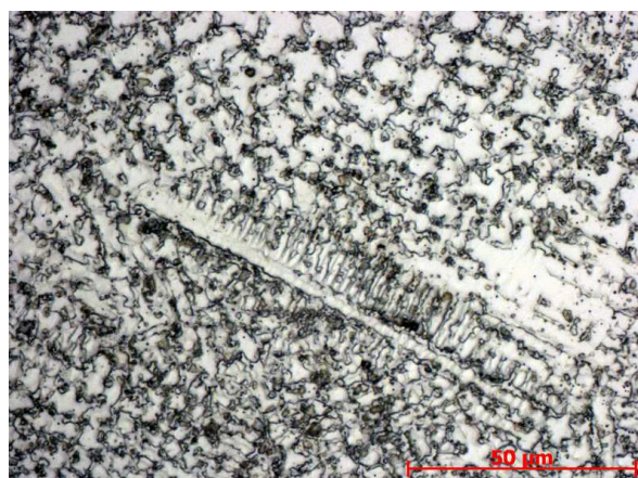
Obr. 57: E2_2000/120/0; POZICE 3 ; formování dendritů s primární a sekundárními osami; leptáno; zvětšeno 500 x
