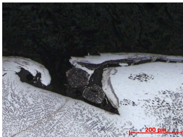
Obr. 70: E2_2000/120/8; příčný řez korozní prasklinou; deformace povrchu laserového návaru; leptáno; zvětšeno 500 x
