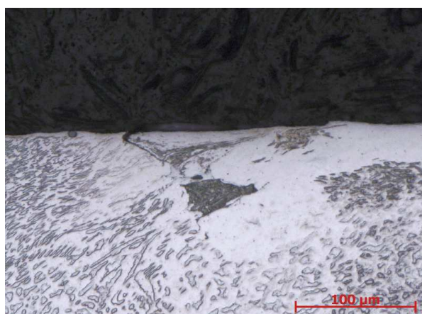
Obr. 71: E2_2500/80/8; příčný řez korozní prasklinou na povrchu laserového návaru; leptáno; zvětšeno 200 x
