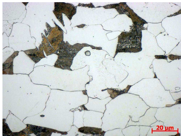
Obr. 25: Podélný řez ocelí S355J2; feriticko-perlitická struktura; leptáno Nital 3 %; zvětšeno 500 x
