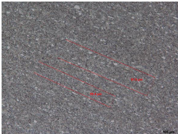
Obrázek 8-43- Mikrostruktura oceli 19436 po žihání na měkko (podélný směr)
