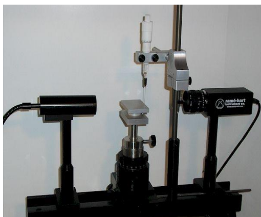
Obrázek 6-1– Ukázka goniometru/tenziometru fy Ramé/Hart [39]
