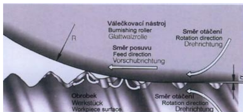
Obrázek 3-4- Princip válečkování [15]
