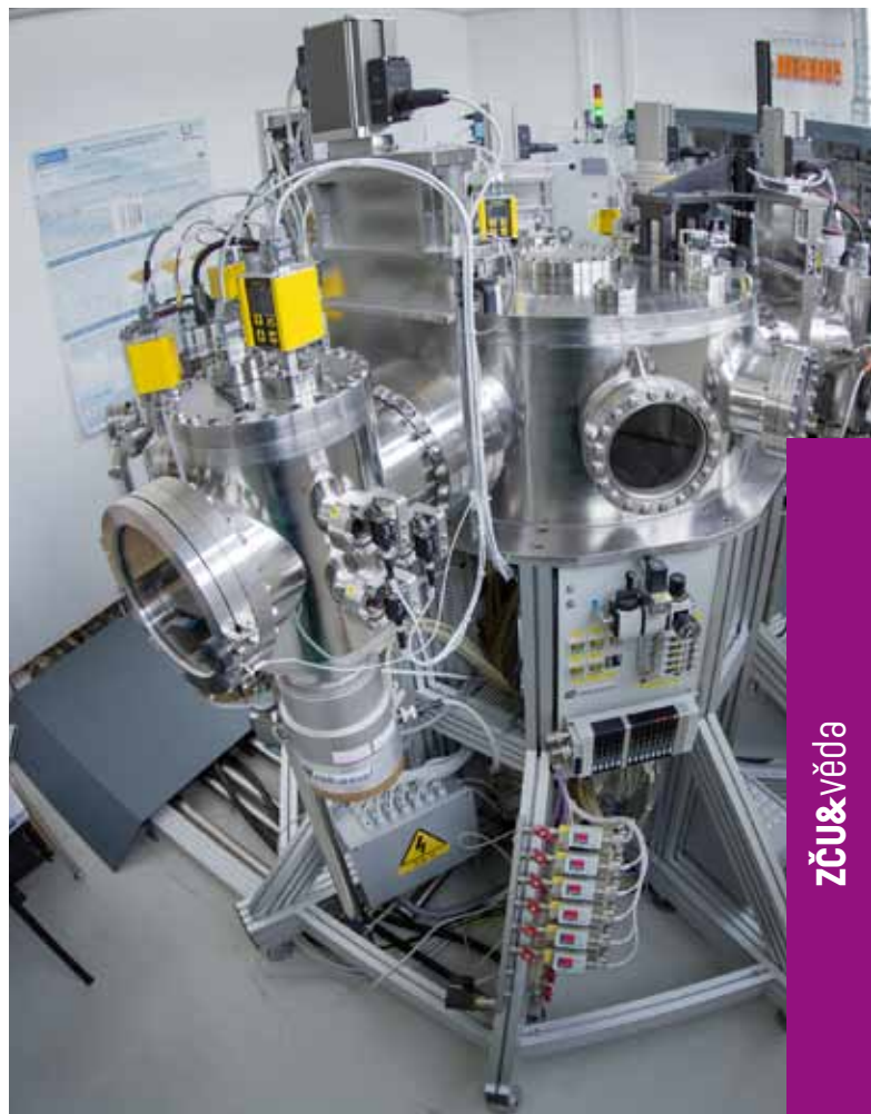
Unikátní pětikomorové naprašovací zařízení pro vývoj tenkovrstvých solárních článků PECVD.
