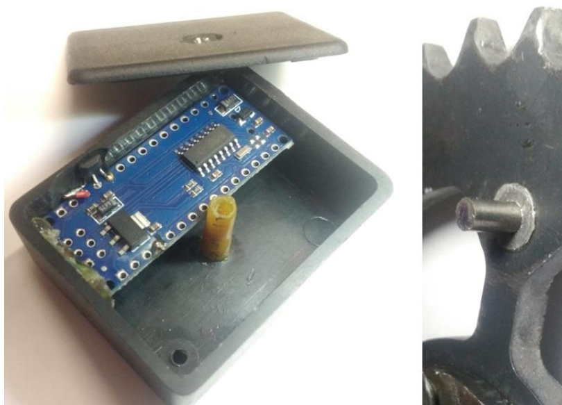
Obr. 7 – Otevřený senzor a magnet v řetězovém kole dynamometru
