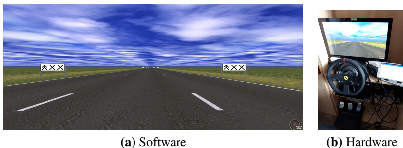
Obrázek 1: Prostředí experimentu dle normy ISO 26022 s dotykovým zařízením pro plnění úkolů podružné činnosti.
