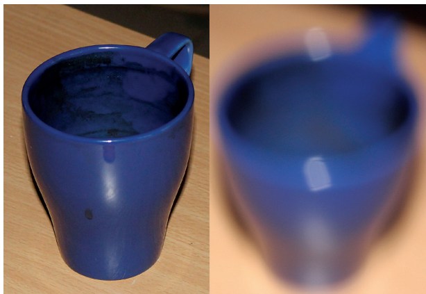
Obr. 3. Fotografie získaná fotoaparátem s objektivem (vlevo) a bez objektivu pomocí dírkové komory (vpravo)
