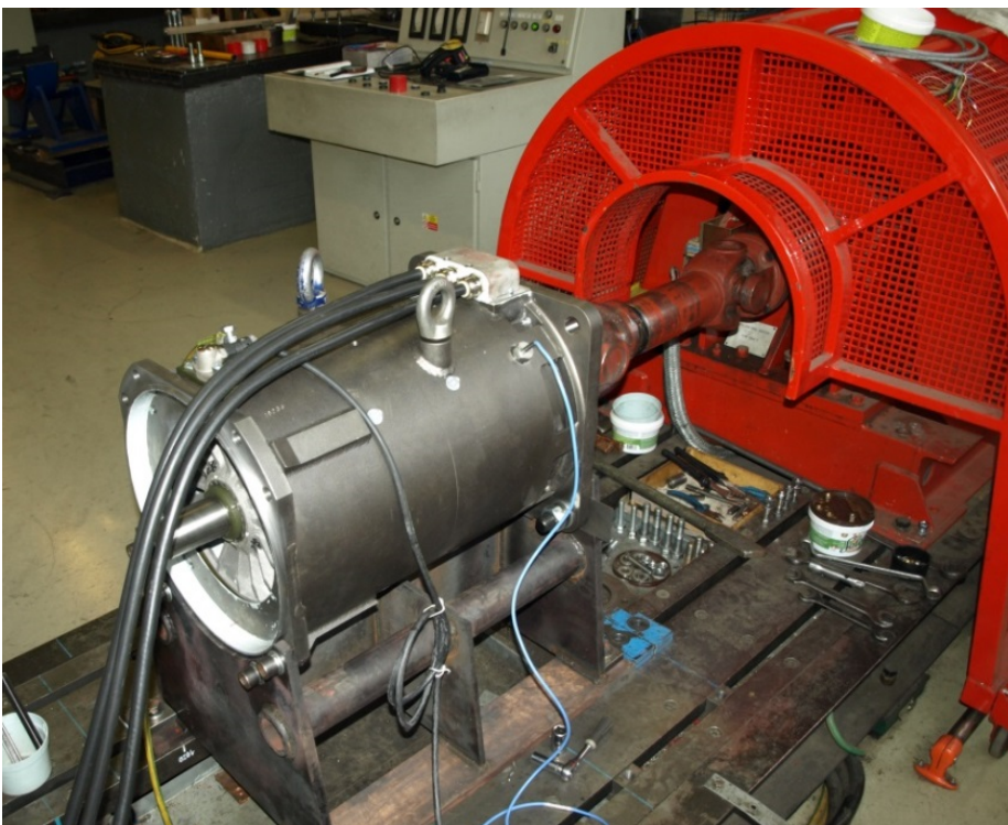
Obr. 10 - Zkouška trakčního motoru na zkušebně.
