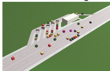
OBR.17 – kupémobily se budou moci spojovat též mechanicky pomocí spřáhla umístěného na výsuvných nápravách. Ke spojování kupémobilů jedoucích stejnám směrem jsou určeny seřazovací terminály s několika rozřazovacími pruhy.
