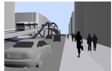
OBR.18 – soupravy kupémobilů budou moci využívat lehká přemostění křižovatek, která zvýší jejich propustnost a zlepší plynulost jízdy.
