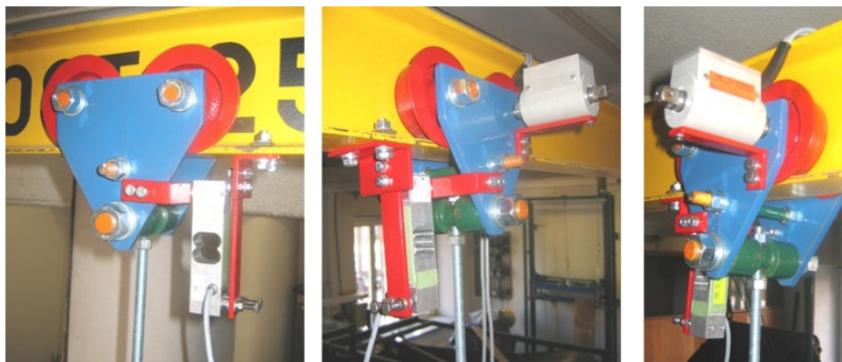
Obr. 9 Realizace zařízení k určování součinitele adheze na mezi prokluzu jeřábového vozíku
