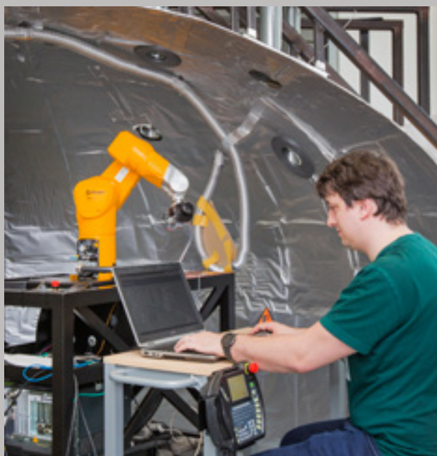
Robot na inspekci víka jaderného reaktoru
