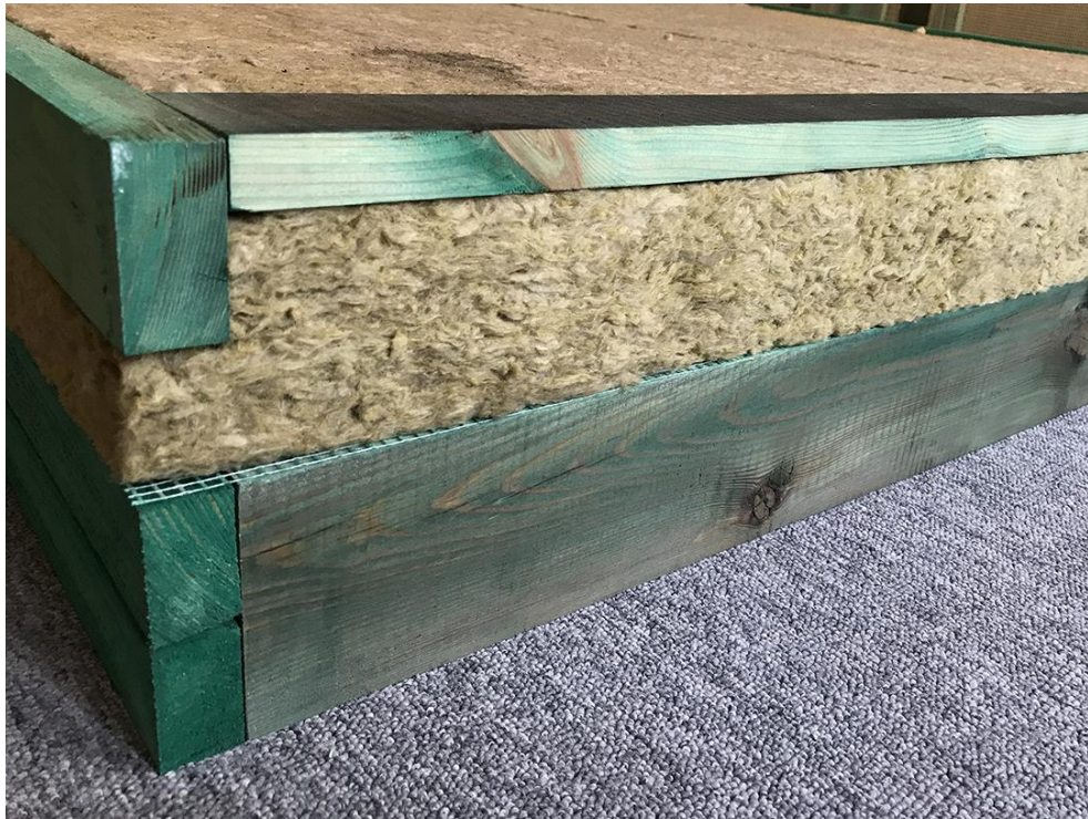
Obr. B. 7: Detail zadní konstrukce rezonátoru – pohled zespoda
