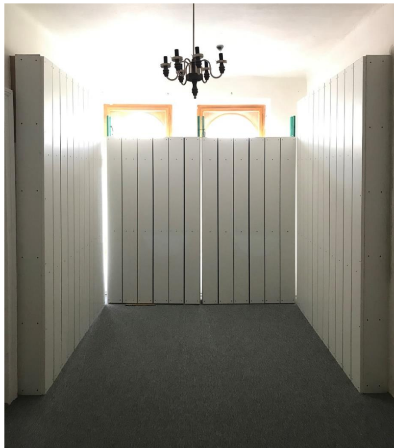
Obr. 6.14: Pohled na zhotovené 4 konstrukce Helmholtzových rezonátorů
