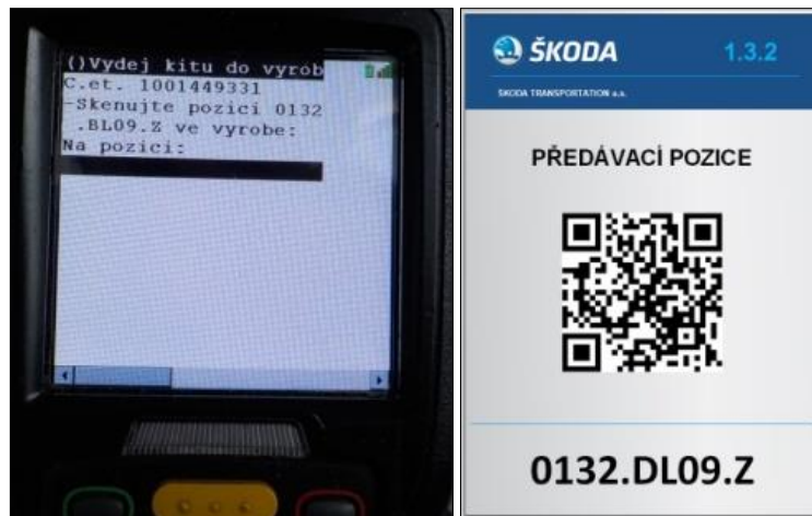
Obr. 30: Obrazovka RFT skeneru při vydání kitu do výroby (vlevo) a QR kód konkrétní pozice ve výrobě (vpravo) [31]
