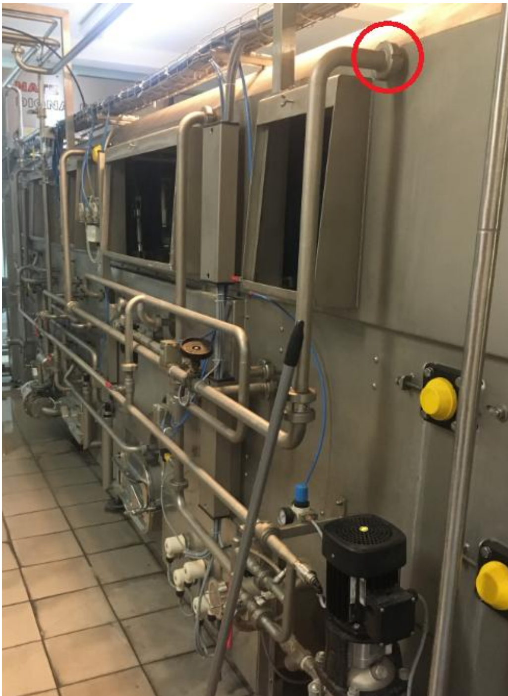
Obr. 36: Stáčecí linka + zavedení „o“ kroužku
