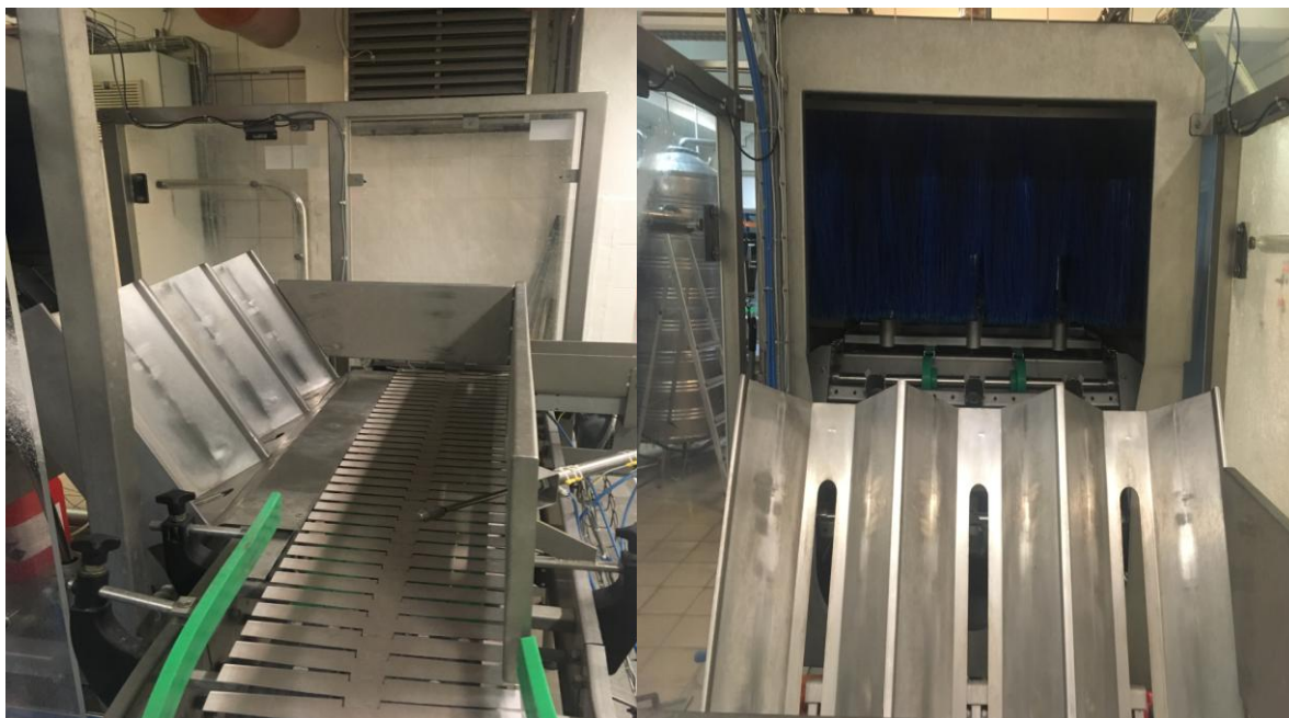
Obr 17: První obrázek (pohled ze strany), druhý obrázek (pohled do linky) lóže a unášecí ústrojí
