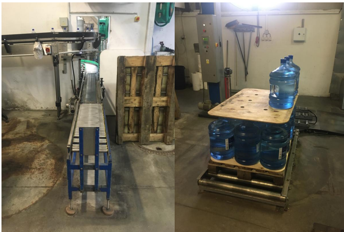
Obr. 21: Levá část: setrvační dopravník, pravá část: válečková rampa a ovinovačka
