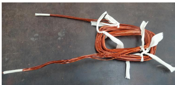
Obr. 12. Vodiče připravené pro "vyspávané" vinutí
