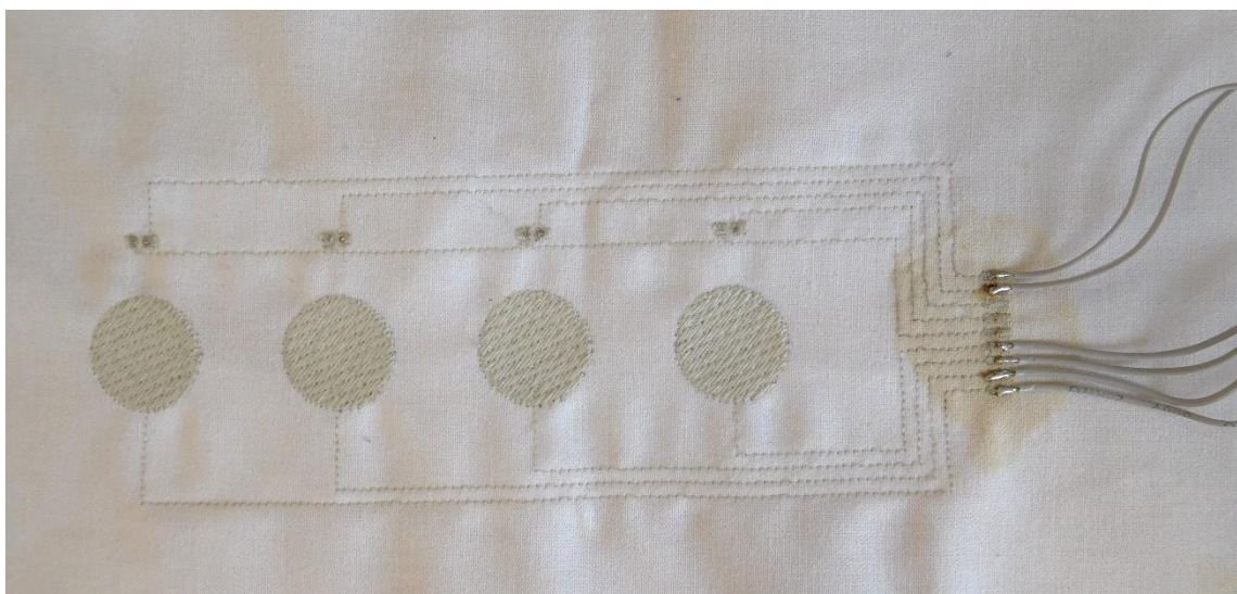
Obr. 66 – Vnitřní vrstva textilních tlačítek – verze 1.1
