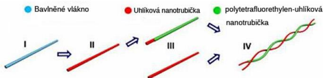
Obr. 21 – Struktura vláken pro TENG [51]
