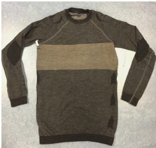
Obr. 6.6 První návrh trika pro monitorování dechové frekvence.
