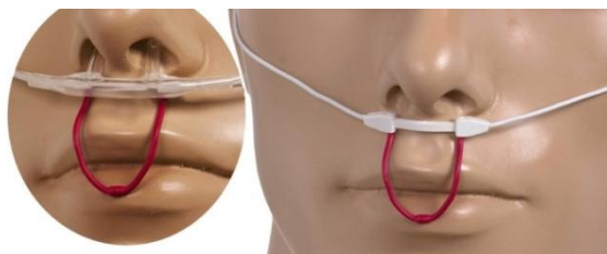
Obr. 5.5 Termistorový senzor průtoku plynu (převzato z [67])
