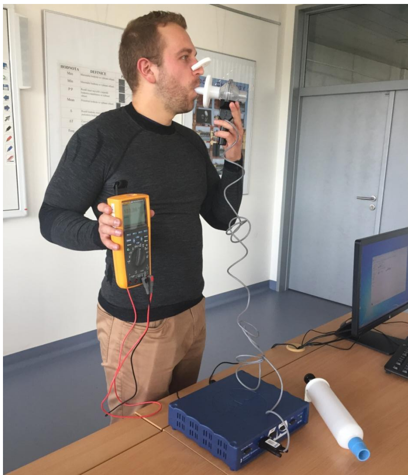
Obr. 7.2 Měřicí kombinace – spirometr a navržený systém.
