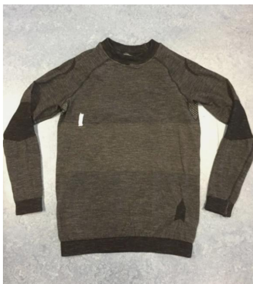
Obr. 6.10 Finální návrh trika pro monitorování dechové frekvence.
