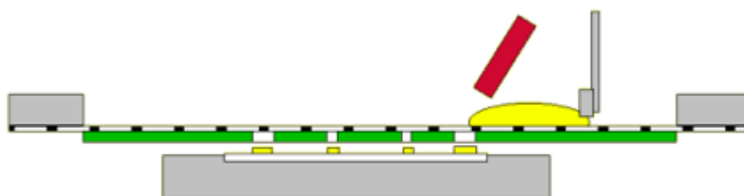
Obrázek 10. Princip šablonového tisku (převzato z [17])
