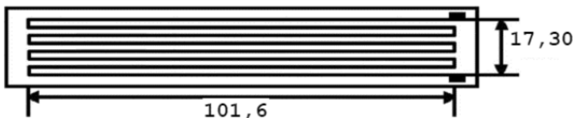
Obrázek 14. Vzorek dle standardu IPC-TM-650, metoda 2.4.3 (převzato z [19])
