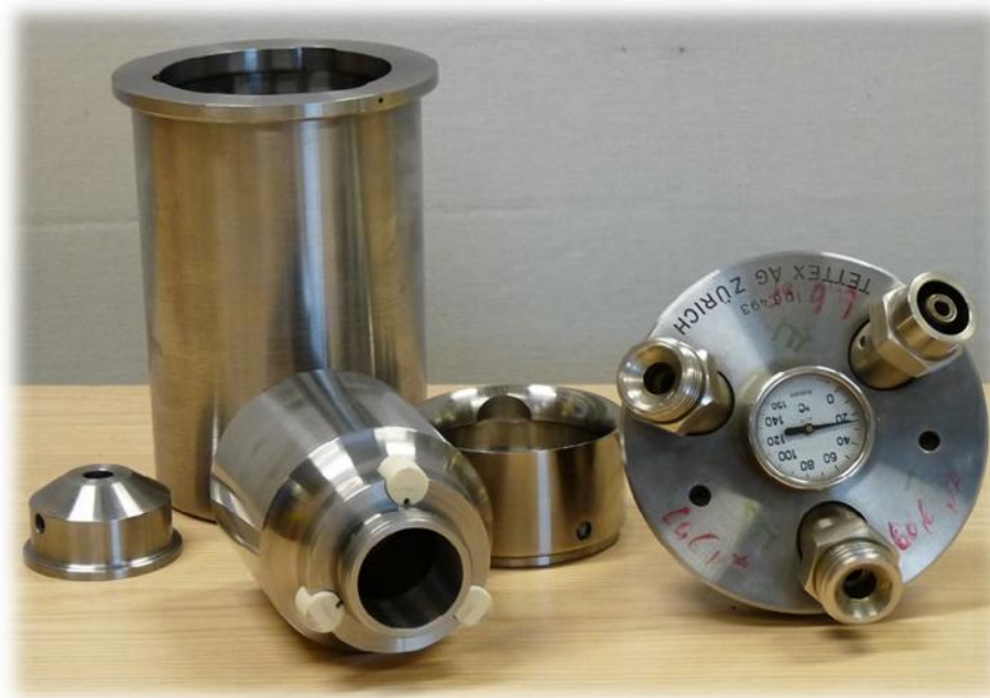
Obrázek 18 - Testovací buňka 2903 pro měření kapalných dielektrik
