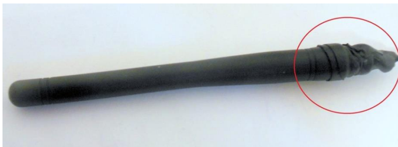
Obr. 4.2.1 Vzorek 2 antény opatřen izolační páskou
