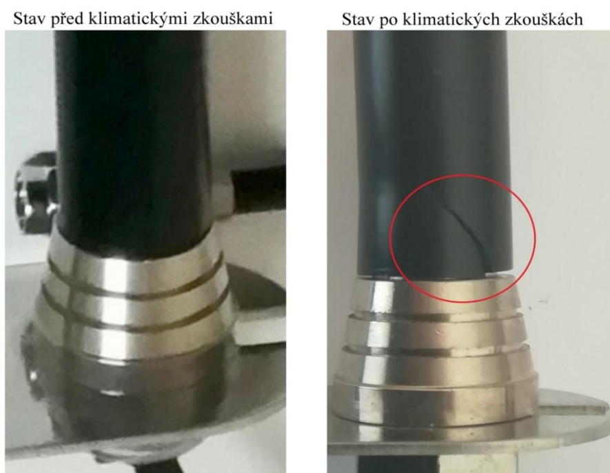
Obr. 5.1.1 Porovnání stavu vzorku 4 před klimatickými zkouškami a po klimatických zkouškách
