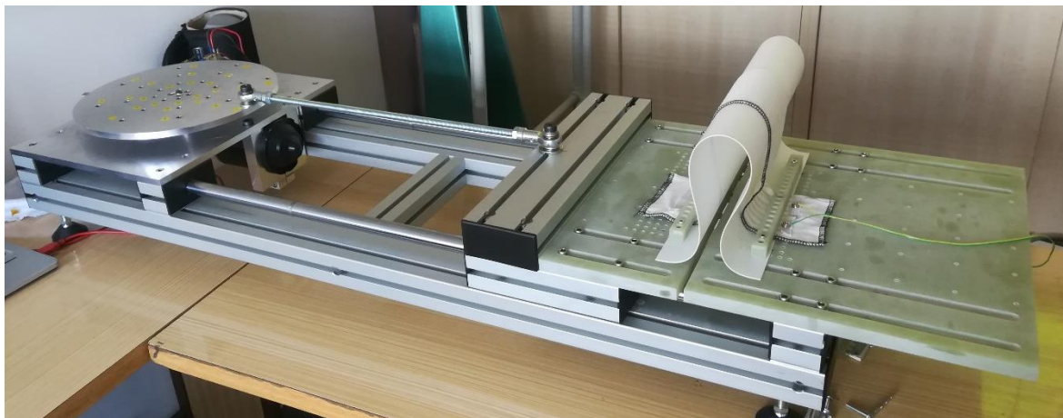
Obr. 20 Ohýbání vzorku A2 na bend testeru
