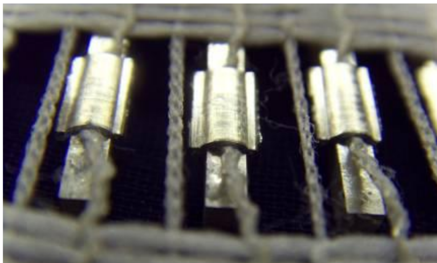
Obr. 12 Kontakty vytvořené krimpováním pro snímač tlaku v sedadle (převzato z [57])
