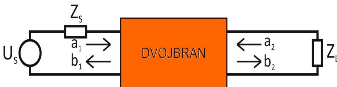
Obrázek 20 Dvojbran s vyznačenými zdrojovými a odraženými vlnami (převzato z [70])
