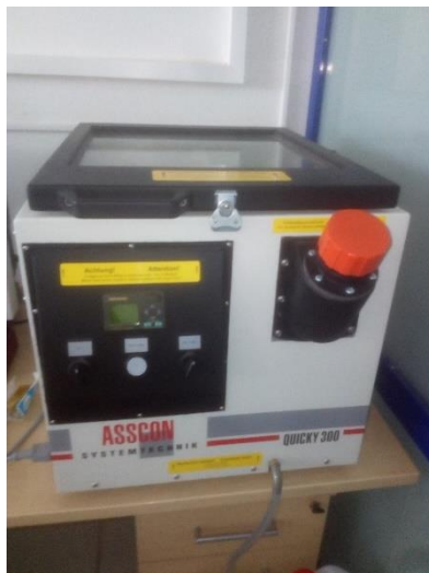
Obr. 25: Zařízení Asscon Quicky 300 – Pájení v parách
