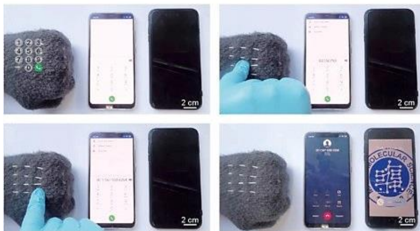
Obr. 38 Inteligentní rukavice s nositelným digitálním ovládacím panelem (převzato z [51])
