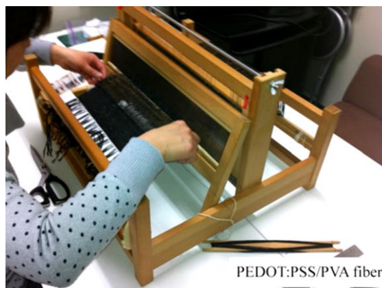
Obr. 14 Tkaní textilních elektrod z PEDOT vláken (převzato z [3])
