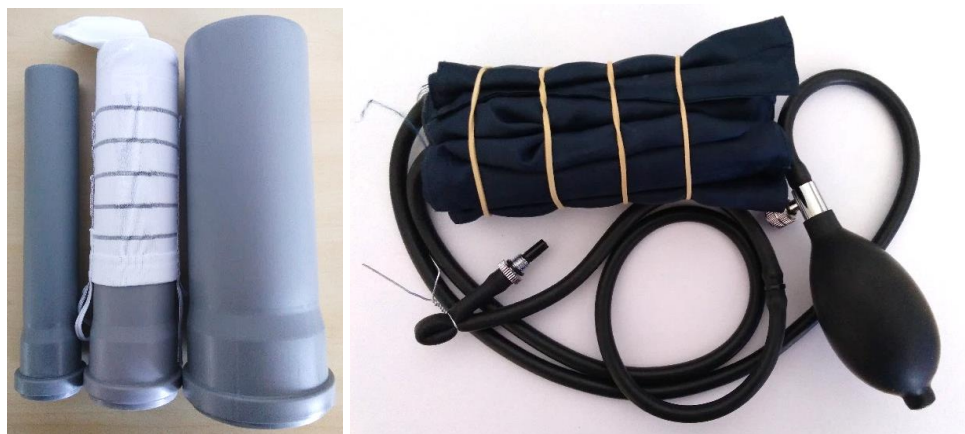
Obr. 77 Použité systémy sloužící k natahování vzorků - trubky a upravený tonometr (zdroj vlastní)
