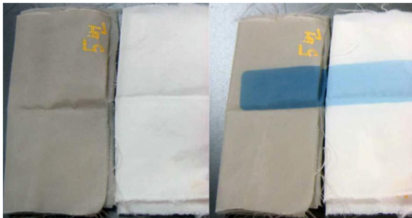
Obr. 6 Látka před a po ozáření UV světlem (převzato z [3])
