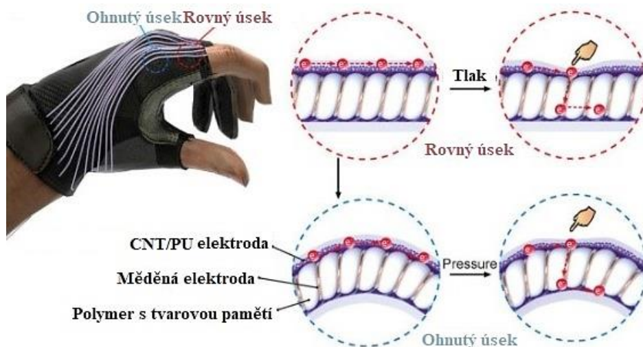
Obr. 37 Schéma textilního senzoru dotyku s jádrovou a plášťovou elektrodou (převzato z [51])
