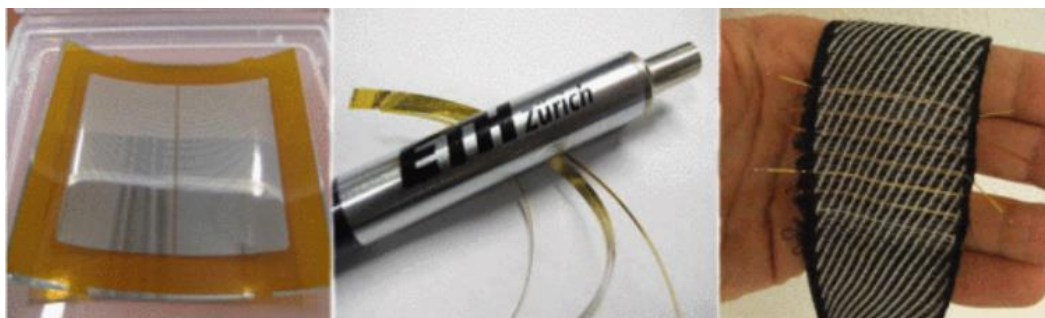
Obr. 20 Fáze výroby textilního senzoru tepla z jednotlivých snímacích proužků (převzato z [29])
