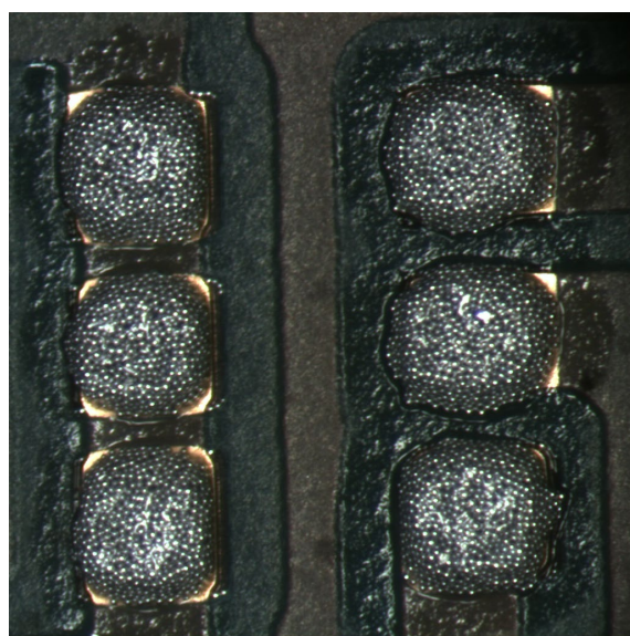
Obr. 67: Nadměrný objem pasty
