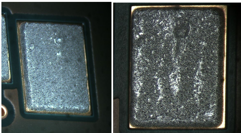
Obr. 55: Vyvýšenina v nanesené pastě
