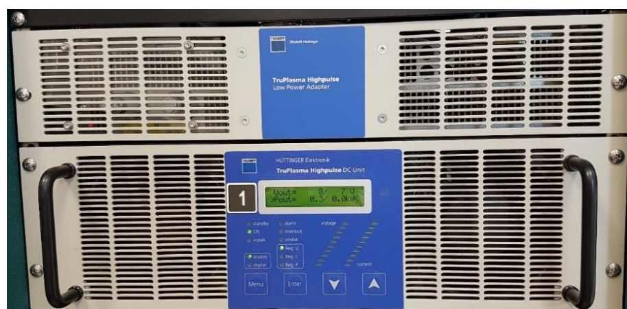
Obr. 4.2: Integrovaný zdroj TruPlasma Highpulse 4002 použitý pro rozprašování vanadového terče
