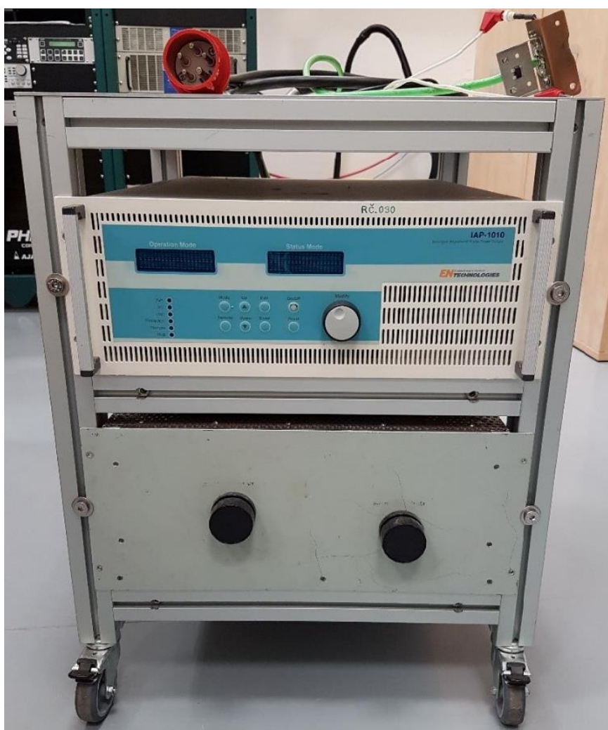
Obr. 4.3: Externí zdroj IAP-1010 použitý pro rozprašování wolframového terče (dopování VO 2 vrstev)
