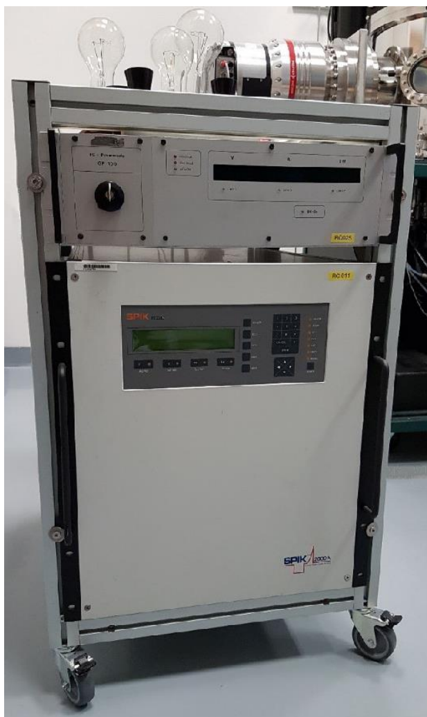
Obr. 4.4: Externí zdroj SPIK 2000A použitý pro rozprašování hořčíkového terče (dopování VO 2 vrstev)
