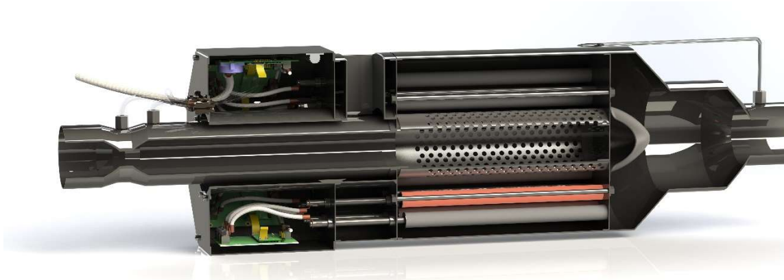
Obrázek 7-9 Řez návrhem 21AE ERDPF filtru s osazenou elektronikou 24V ERDPF V1 – CAD
