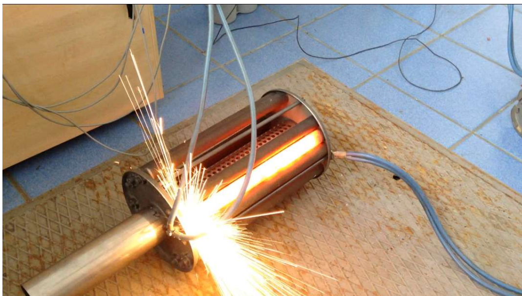
Obrázek 6-8 Zkrat mezi rámem filtru a aktivním elementem v průběhu iniciace regenerace.
