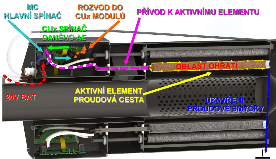
Obrázek 6-3 Znárodnění proudové regenerační smyčky - zahřívání aktivního elementu pomocí 24V ERDPF V2
