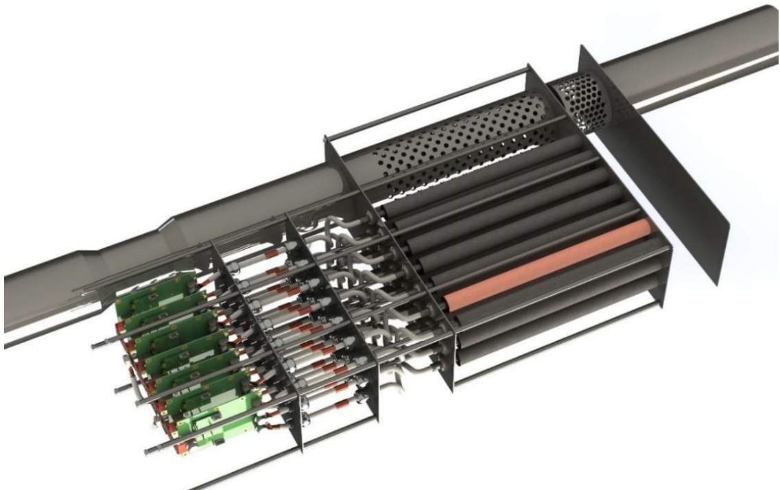
Obrázek 7-12 Návrh 21 AE ERDPF flat filtru se vzduchovou mezerou - CAD
