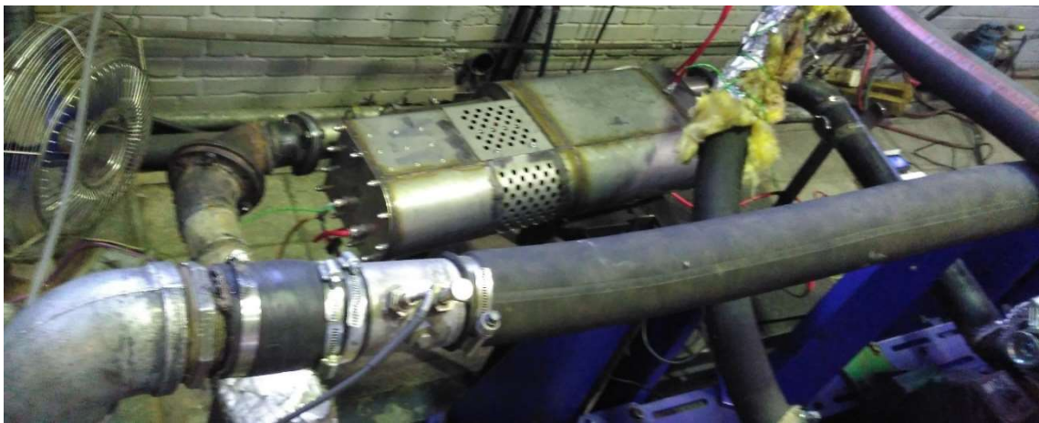
Obrázek 12-11 ERDPF filtr nainstalovaný v testovací laboratoři IDEM
