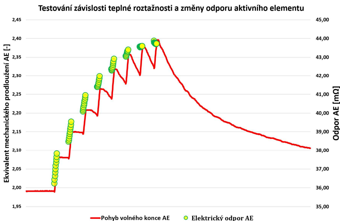
Obrázek 6-10 Měření vnitřního odporu a tepelné roztažnosti aktivního elementu
