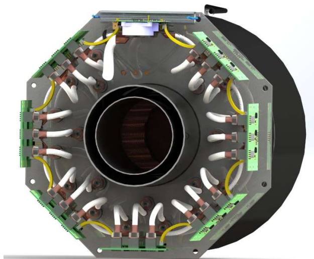
Obrázek 8-17 Vizualizace propojení modulů v kruhové topologii v těle ERDPF filtru - CAD
