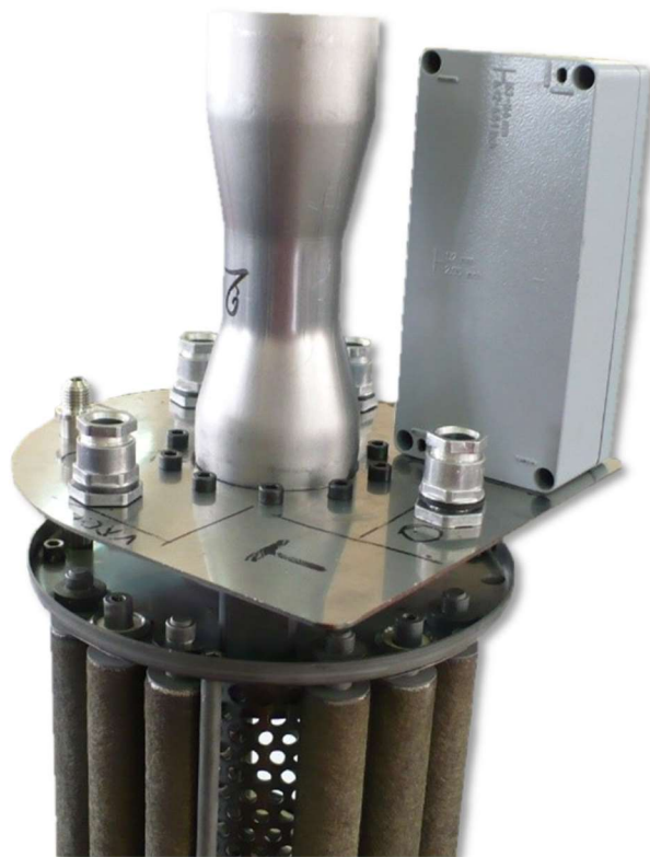
Obrázek 9-1 Výroba prototypu měření hmotnostního průtoku spalin na principu Venturiho efektu
