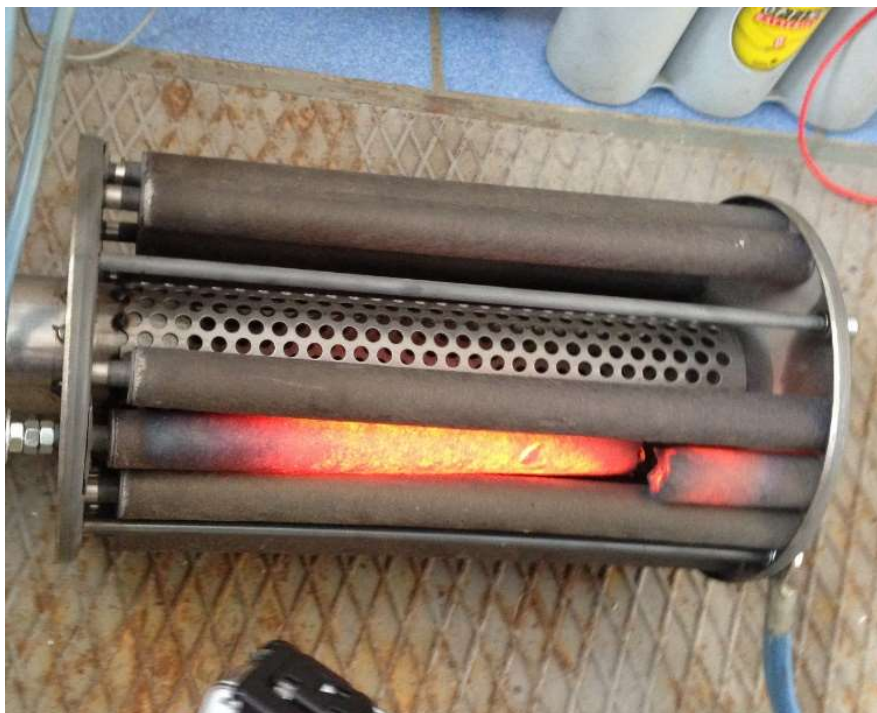
Obrázek 6-9 Zničený aktivní element v průběhu iniciace regenerace.
