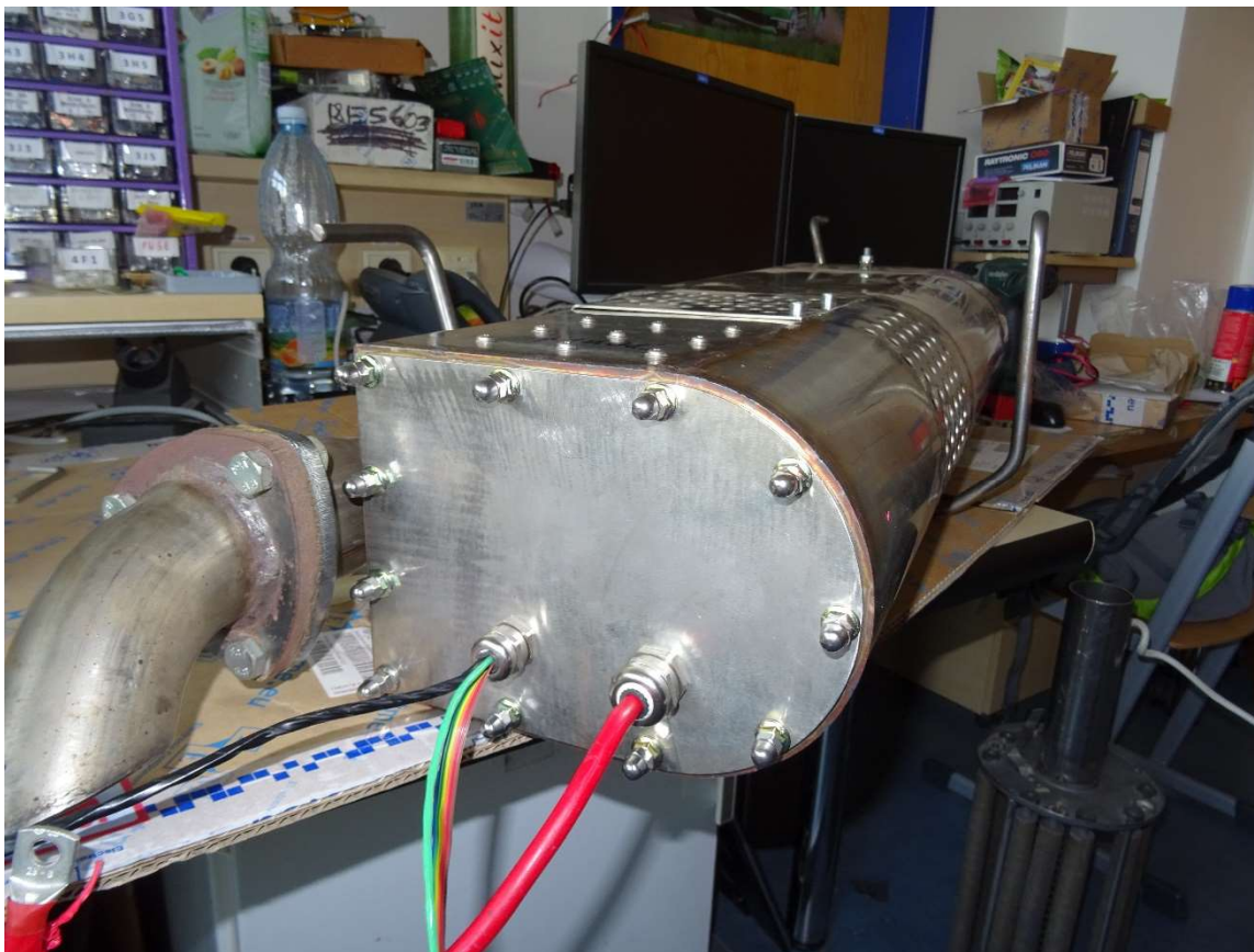
Obrázek 12-6 Zakrytý filtr připravený k instalaci na vozidlo
