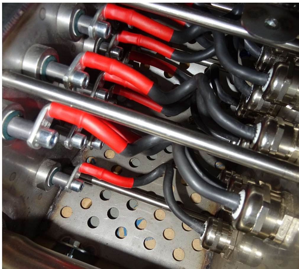
Obrázek 12-2 Detail chladicí komory s dilatačními smyčkami
