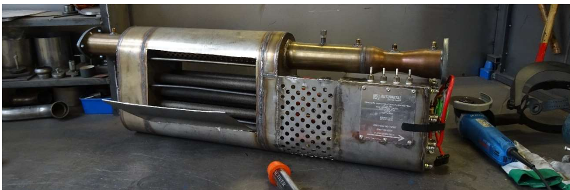
Obrázek 12-15 Analýza otestovaného vzorku ERPDF filtru
