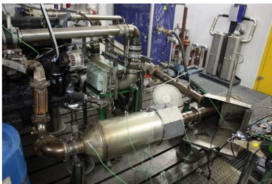
Obrázek 7-3 Testování teplotního rozložení u prototypu ERDPF filtru v laboratoři TÜV SÜD Czech s.r.o.
