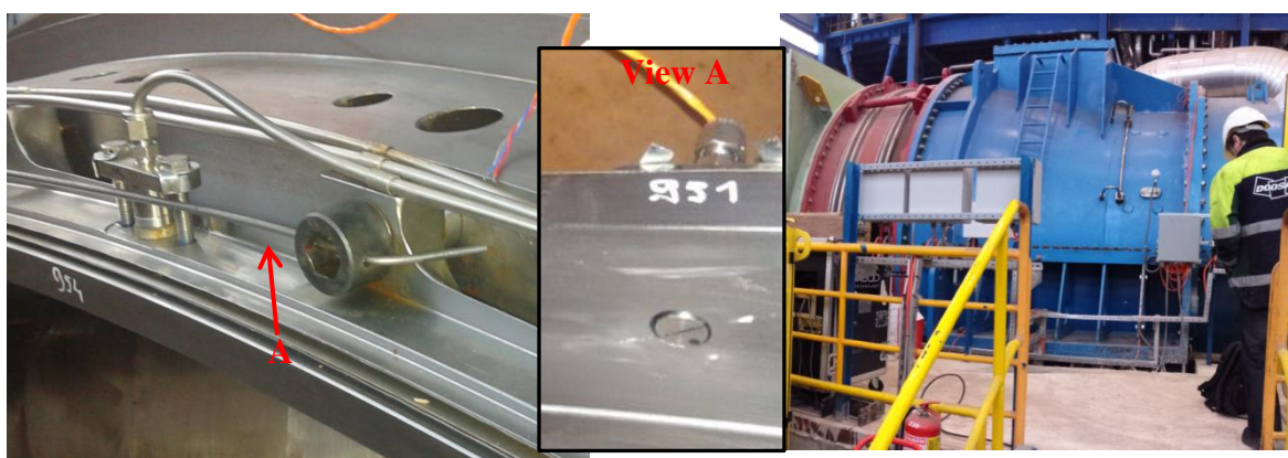
Obrázek 59 - Instalace senzorů do deflektoru a celkový pohled na smontovanou turbínu (nízkotlaký díl)
