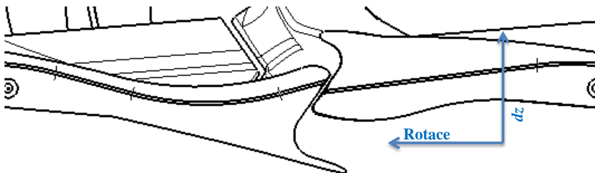
Obrázek 18 - Bandáž lopatky a souřadnicový systém
