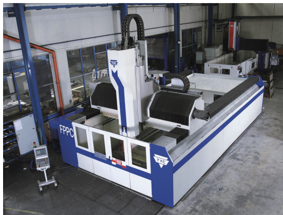
Obrázek 2: Ukázka portálového centra společnosti TYC (horní gantry) [2]
