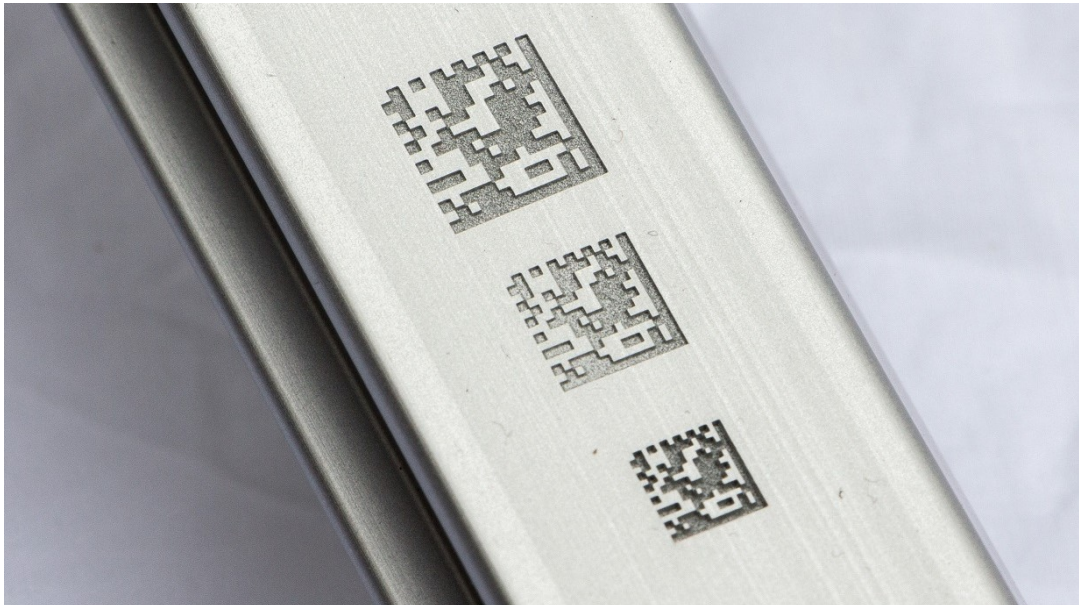
Obrázek 14: Ukázka laserově gravírovaného povrchu [19]
