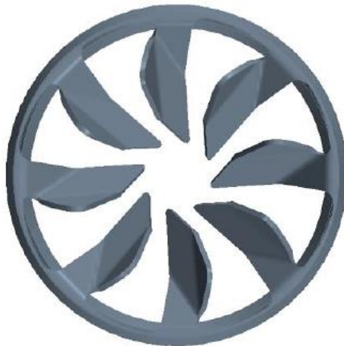
Obr. 21 Osmibřítý statický mixér [20]
