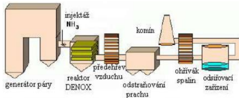
Obr. 17 Uspořádání DeNOx při SCR ve vysokoprašném prostředí [14]
