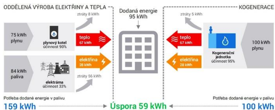
Obr. 6 Znárodnění energetických toků s a bez kogenerace [9]
