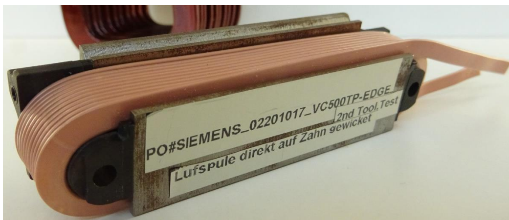
Obr. 1.3: Cívka zubového vinutí obdélníkového průřezu
