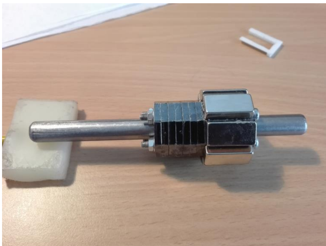
Obr. P-14.8: Proces lepení magnetů osmipólového rotoru
