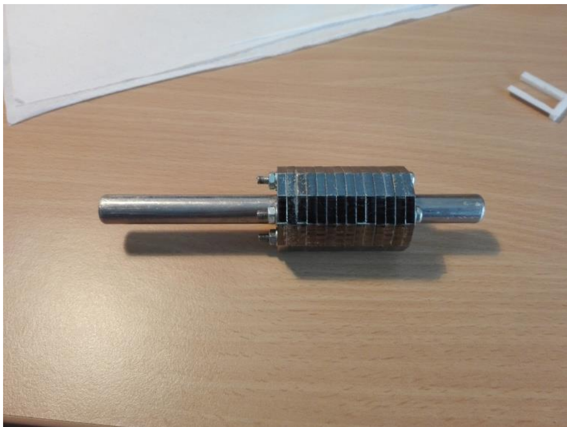
Obr. P-14.7: Sestavené plechy rotoru na hřídeli
