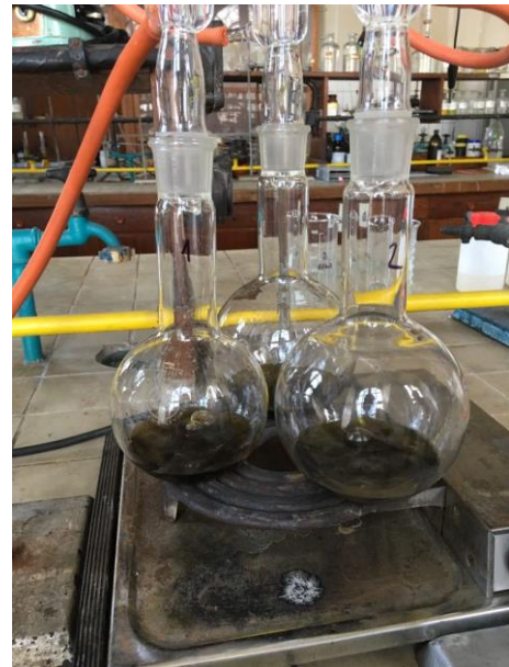
Obrázek 10 – Zelenohnědé zbarvení částečně zreagovaného dichromanu draselného
