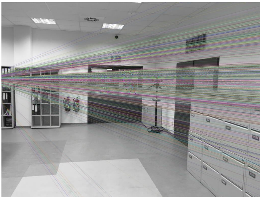
Obr. 24 Znáornění epipolárních přímek vedených významnými body ve snímku
