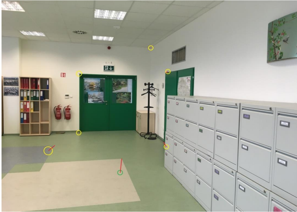
Obr. 26 Transformované snímkové souřadnice obrazů vřícovacích bodů ve vstupním snímku
