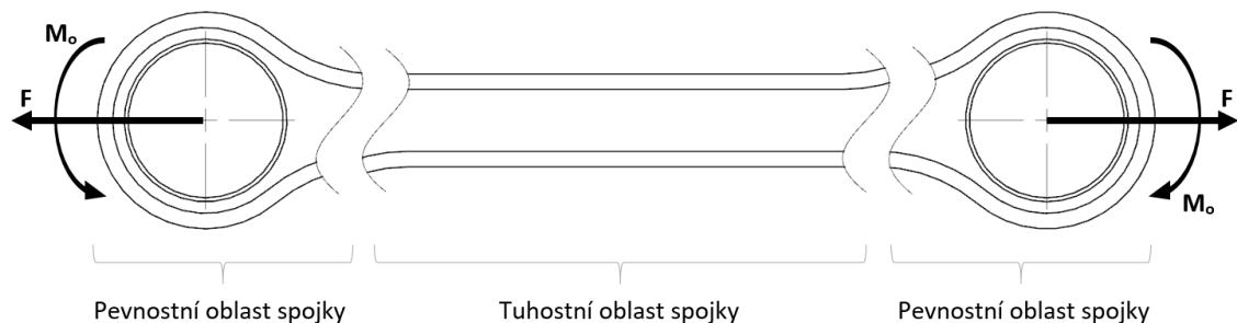
Obr. 9-1 Schéma univerzální pružné spojky
