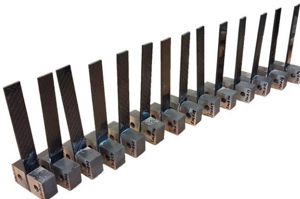
Obr. 10-18 Vyrobené zkušební vzorky pro DCB test.
