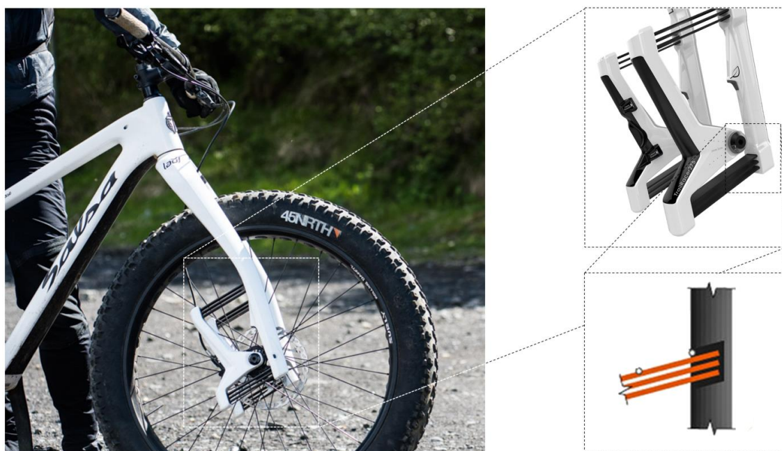
Obr. 7-6 Přední vidlice s kompozitními břitovými pružinami Lauf Fork a detailem uložení pružných břitů.
