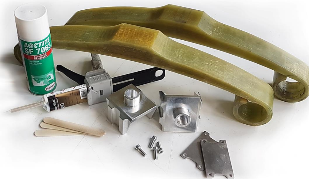
Obr. 8-14 Příprava na kompletaci funkčních vzorků kompozitních listových pružin.
