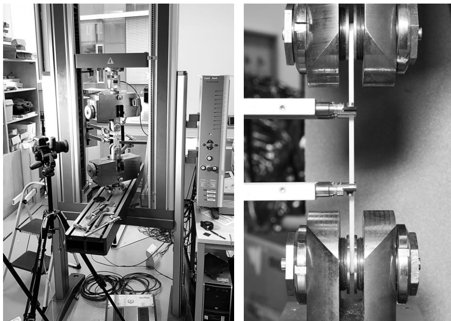
Obr. 9-38 Experimentální měření pevně uchycených oček na zařízení Zwick Roell Z050.
