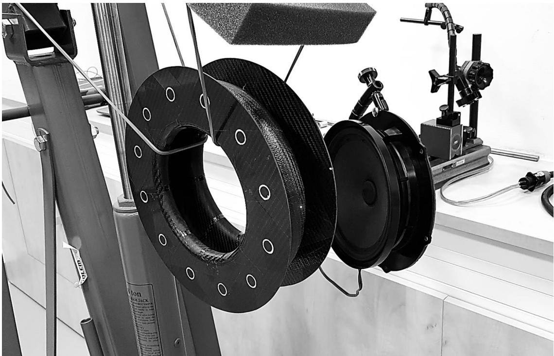
Obr. 10-75 Uložení a buzení spojky při modální analýze.
