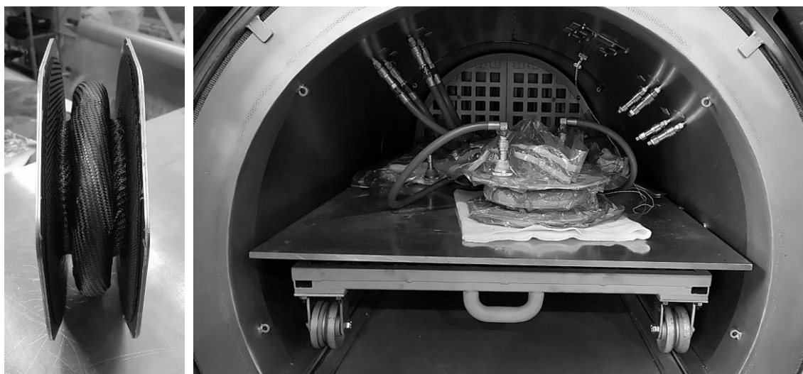
Obr. 10-74 Výroba funkčního vzorku vlnovcové spojky.
