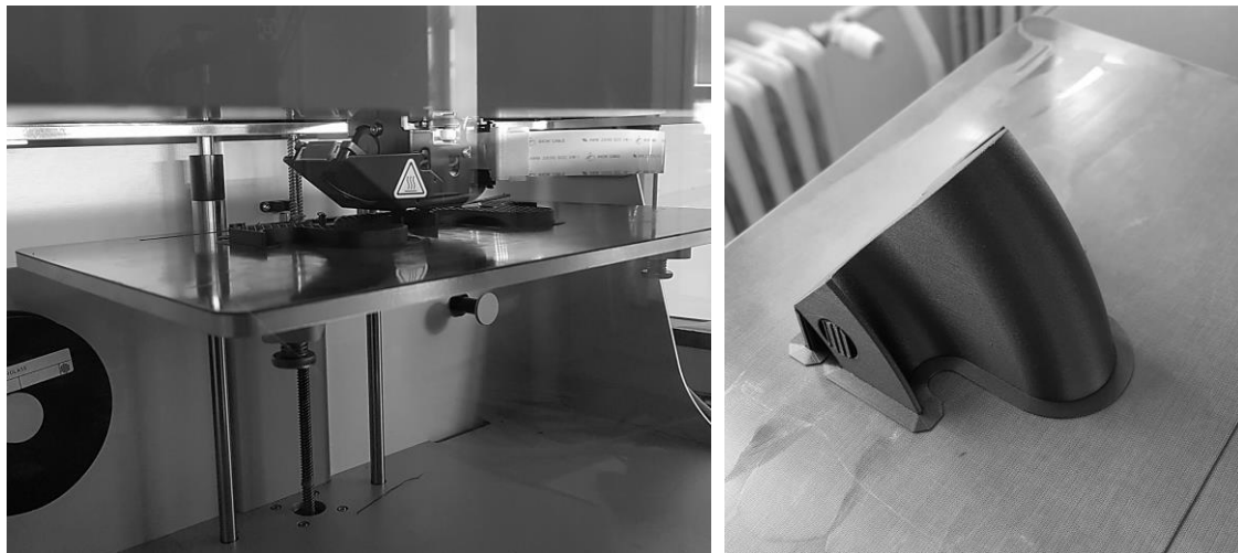
Obr. 10-71 Výroba segmentu jádra vlnovcové spojky na FDM tiskárně Markforged MarkTwo.
