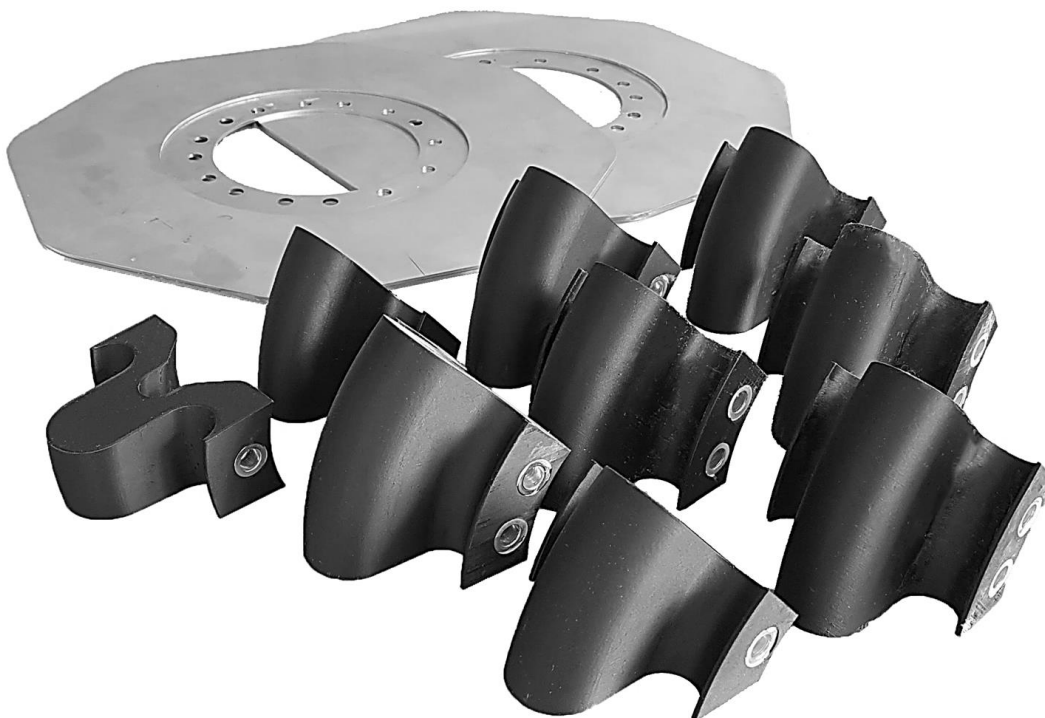
Obr. 10-72 Díly skládané formy pro výrobu funkčního vzorku vlnovcové spojky.
