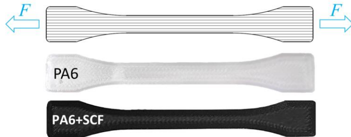
Obr. 10-56 Vzorky typu HPS z materiálu PA6 a PA6+SCF.
