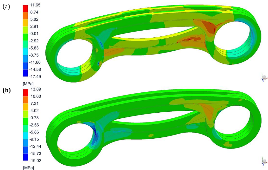
Obr. 9-57 Hlavní normálové napětí ve směru 22: (a) kritické kombinované zatížení v tahu, (b) kritické kombinované zatížení v tlaku.
