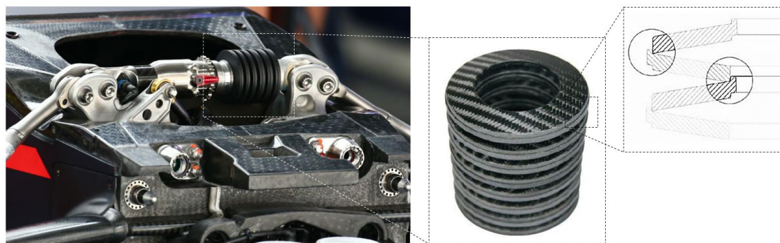
Obr. 7-3 Talířová kompozitní pružina od společnosti Hyperco; řez (vpravo) detail zajištění jednotlivých segmentů pružiny v radiálním směru.
