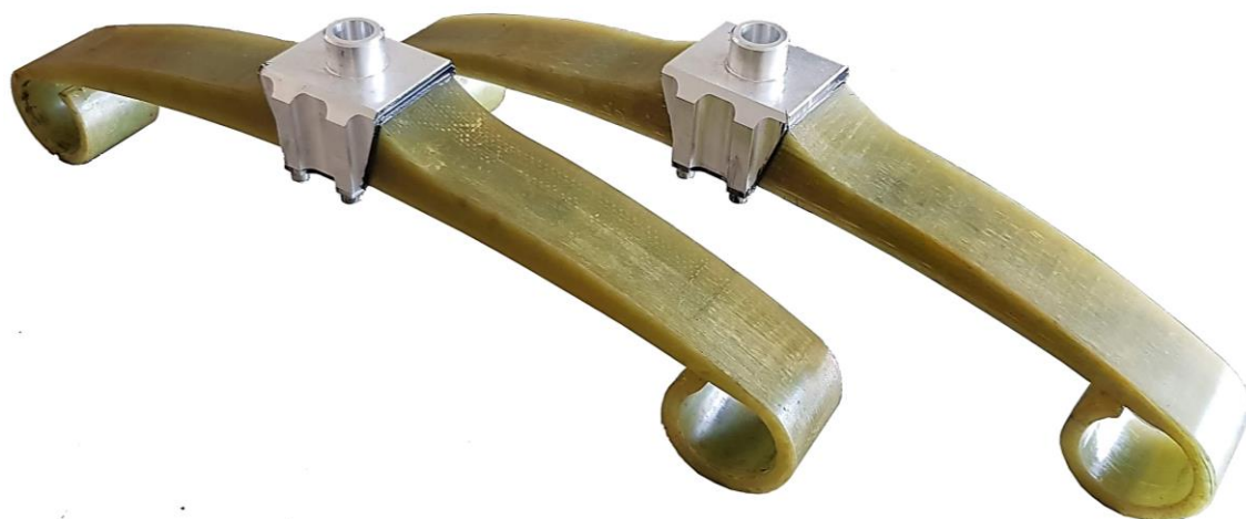
Obr. 8-15 Funkční vzorky navržené kompozitní listové pružiny.
