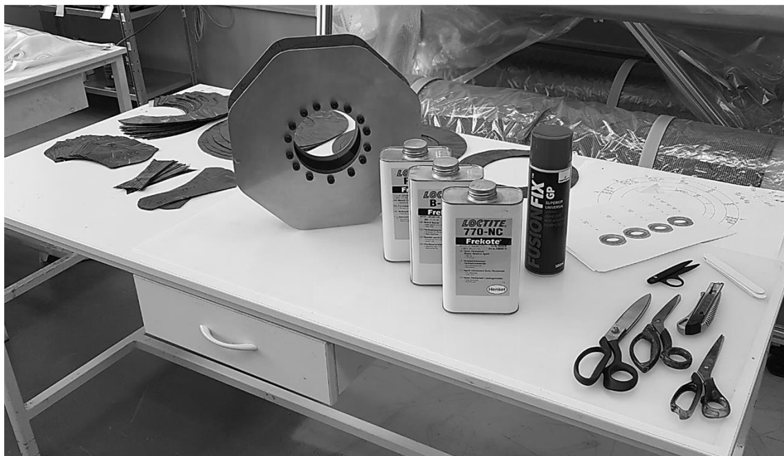
Obr. 10-73 Příprava formy pro výrobu funkčního vzorku vlnovcové spojky.
