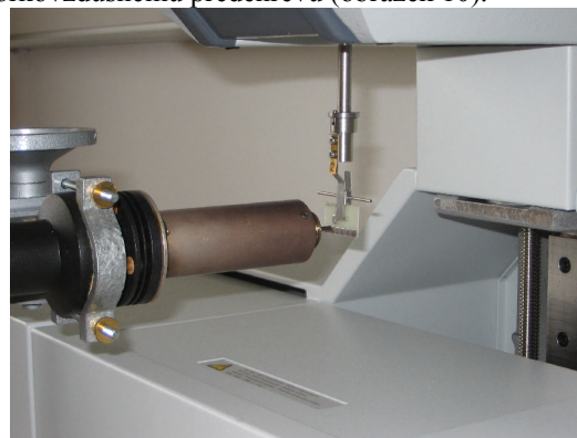
Obr. 10: Doplnění testeru MUST II horkovzdušným předehřevem
