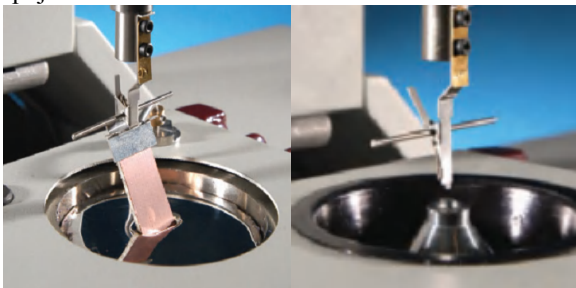
Obr. 8: Měření smáčivosti pomocí testeru MUST II a) ve vaničce s roztavenou pájkou b) na kuličce roztavené pájky [1]
