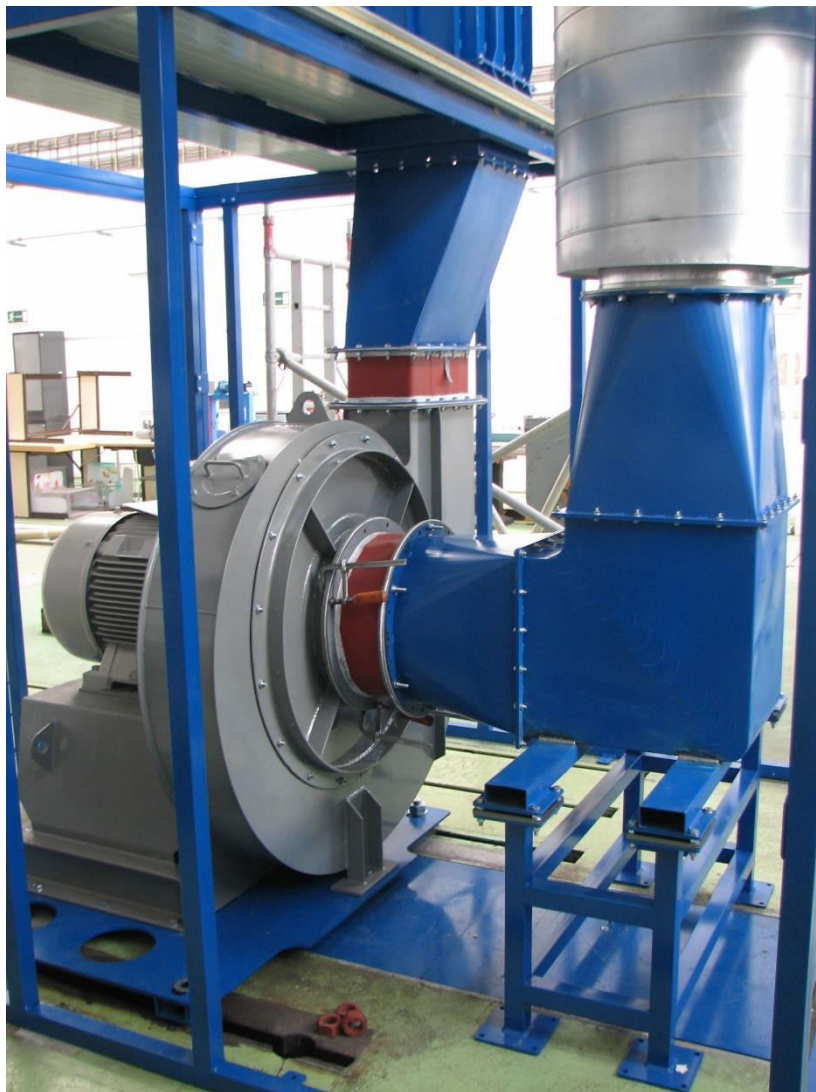
Obr. 25 Foto kompresoru v experimentální smyčce
