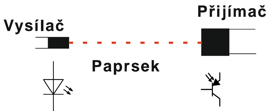
Obr. 6 - jednocestná závora a její princip
