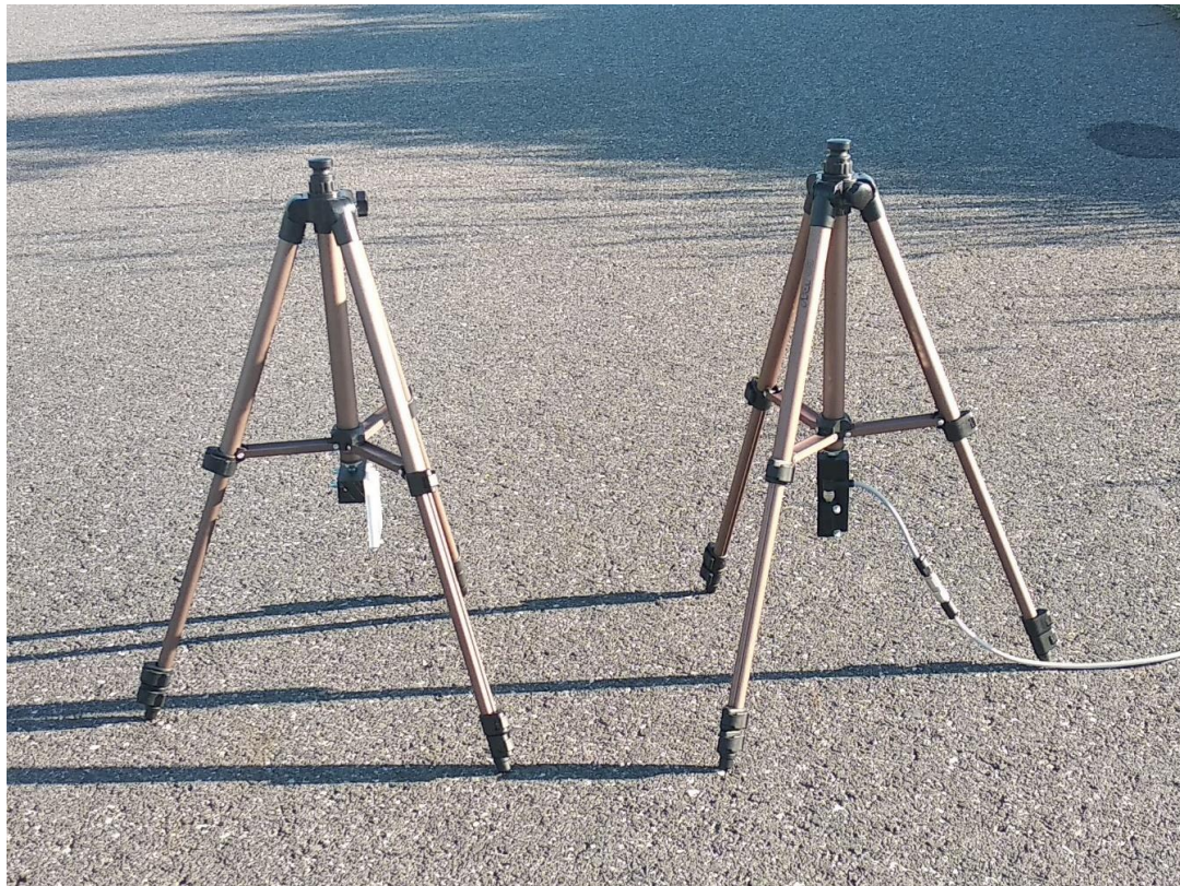
Obr. 15 - Stativ s uchycenou optickou závorou
