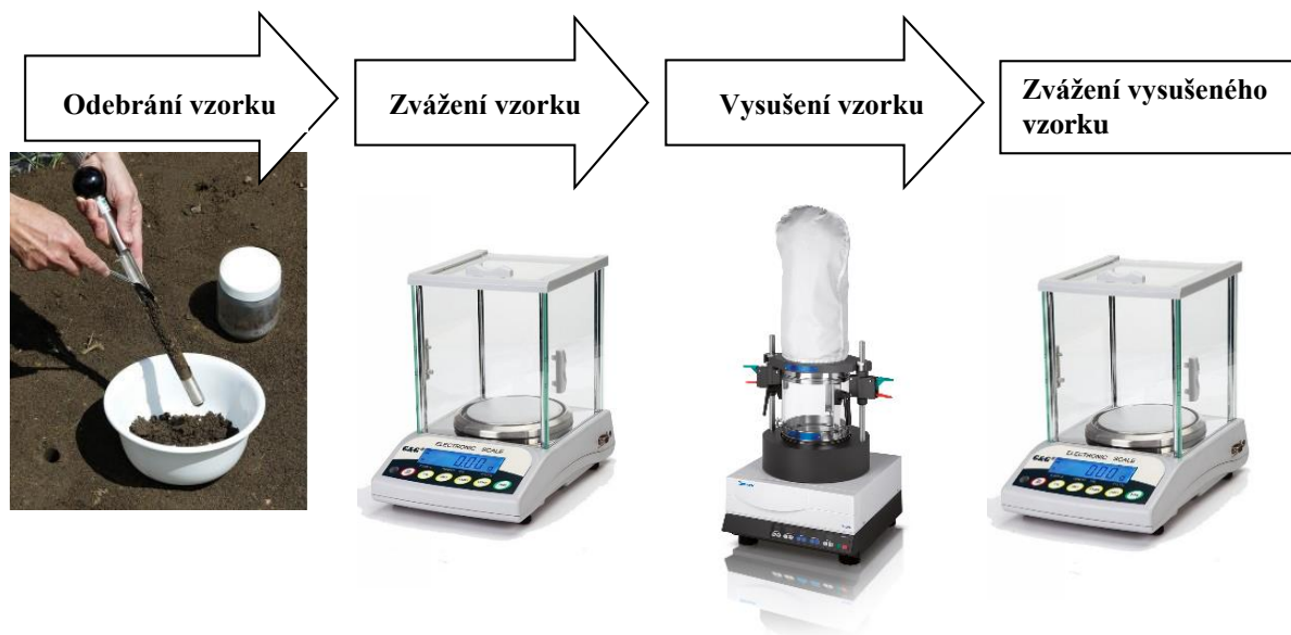
Obr. 2.2 Postup zjišťování vlhkosti gravimetrickou metodou [14-16]
