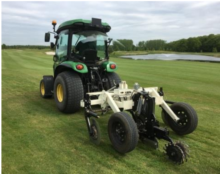
Obr. 3.2 Senzor on-the-go umístěný na traktoru [86]
