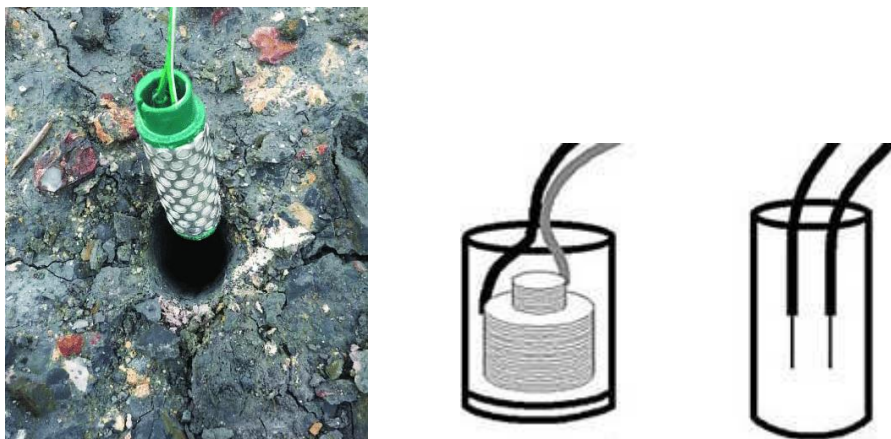
Obr. 2.20 Sádřový bloček Watermark (vlevo) a řez senzoru zkonstruovaný ze sádřových bločků (vpravo) [38, 39]
