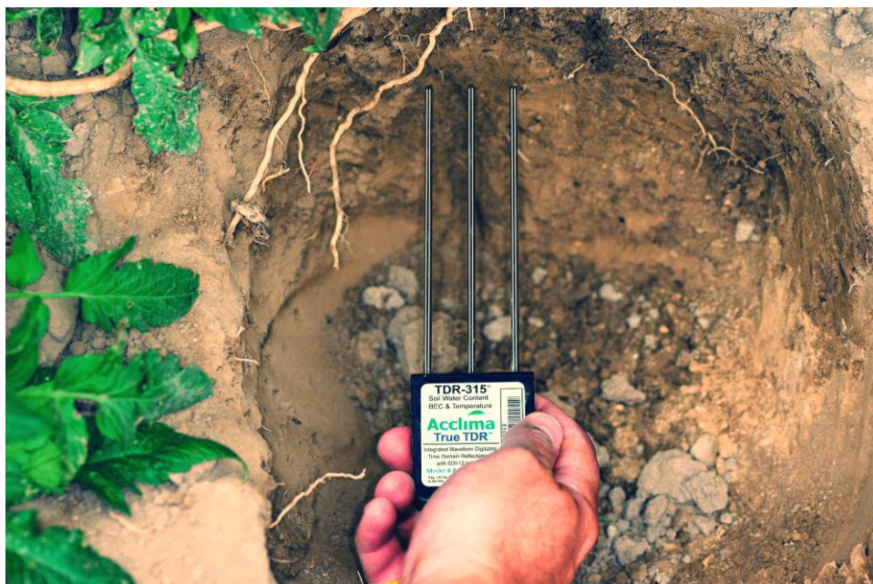
Obr. 2.10 TDR sensor s třemi hrotovitými elektrodami [23]
