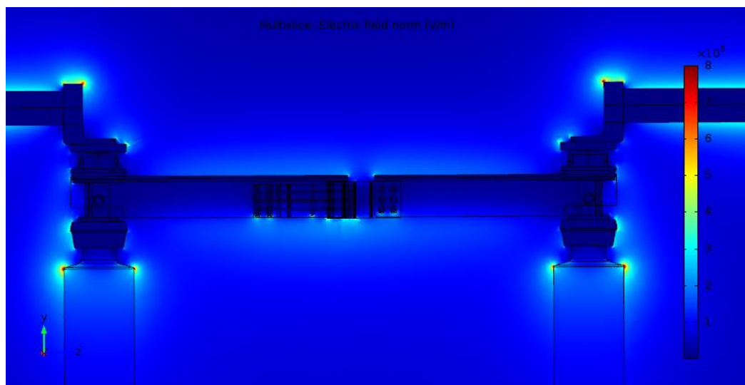
Obrázek 4.28 - Rozložení intenzity elektrického pole v oblasti proudové dráhy
