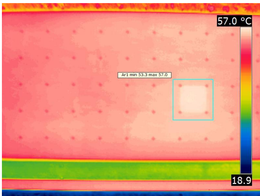
Obrázek 34 Modul s označením 16F s vadným FV článkem – zadní strana
